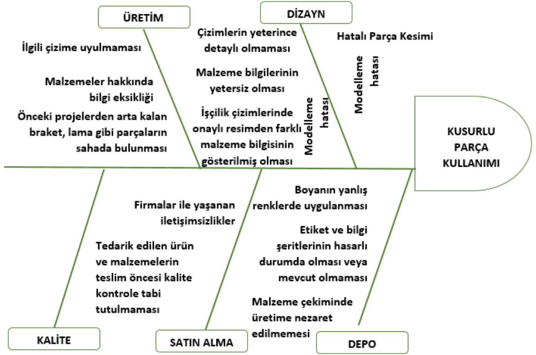
Şekil 7.3. “Kusurlu Parça Kullanımı” hatası için oluşturulan neden – sonuç diyagramı.
