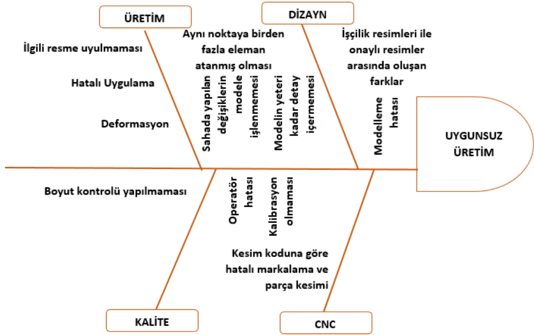
Şekil 7.2. “Uygunsuz Üretim” hatası için oluşturulan neden – sonuç diyagramı.
