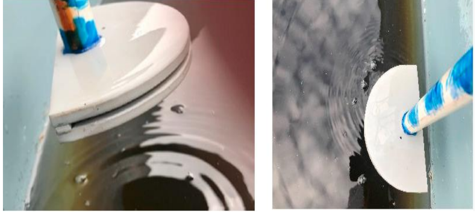
Şekil 6.1. Enjeksiyon katmanları için difüzör.
