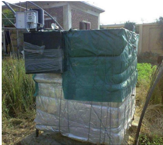
Şekil 5.4. Güneş havuzlarında ısısal yalıtım.
