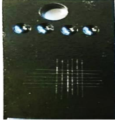
Şekil 6.8. İşlemsiz S355J2 çeliğinin kataforez kaplama sonrası yapışma test yüzeyi.
