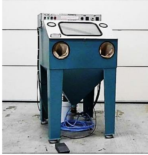
Şekil 3.7. Hava püskürtmeli bilyalı dövme cihazı [9].
