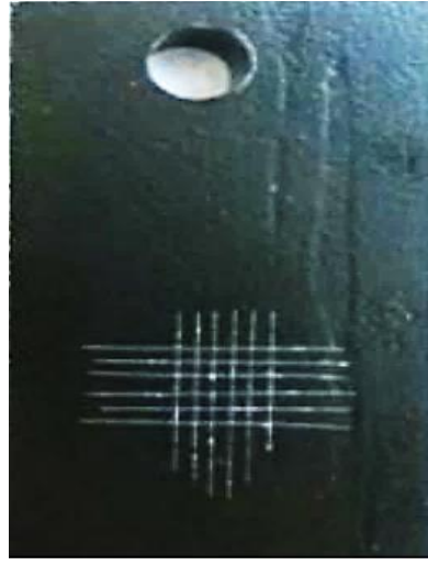
Şekil 6.7. Bilyalı dövme uygulanmış QSte 690 TM çeliğinin kataforez kaplama sonrası yapışma test yüzeyi.
