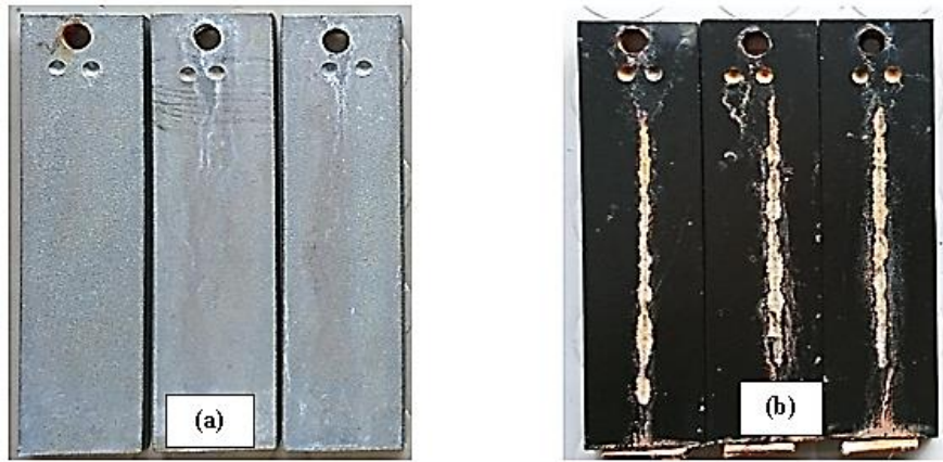
Şekil 6.5. Bilyalı dövme işlemi uygulanan S355J2 çeliğinin (a) alkali çinko nikel kaplamalı ve (b) kataforez kaplamalı numunelerin korozyon sonrası yüzey görüntüleri
