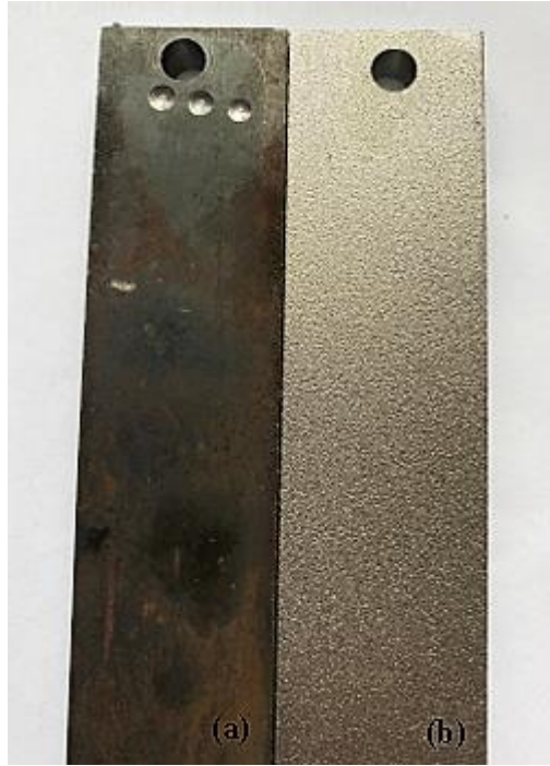
Şekil 5.2. QStE TM 690 çeliğinin, (a) işlemsiz ve (b) bilyalı dövme işlemi uygulanmış.
