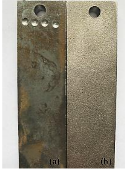
Şekil 5.1. (a) S355J2 yapı çeliğinin işlemsiz plaka, (b) S355J2 yapı çeliğinin bilyalı dövme işlemi uygulanmış.
