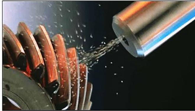
Şekil 3.2. Bilyalı dövme işlemi [10].
