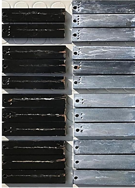
Şekil 6.1. İşlem görmemiş ve bilyalı dövme işlemi uygulanmış QSte 690 TM ve S355J2 çeliklerinin kataforez ve alkali çinko nikel kaplama sonrası korozyon yüzey görüntüsü.
