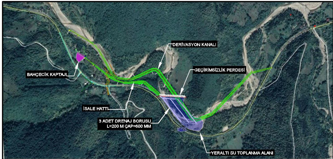
Şekil 5.2. Bahçecik Yeraltı Barajı uydur görüntüsü üzerine proje aşamalarının konumları [32].
