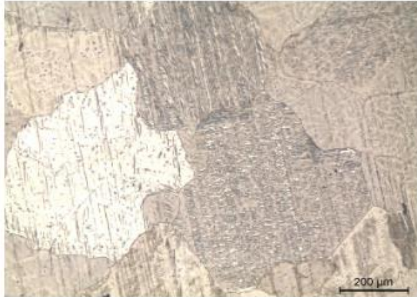
Şekil 5.1. AZ053 alaşımına ait mikroyapı.
