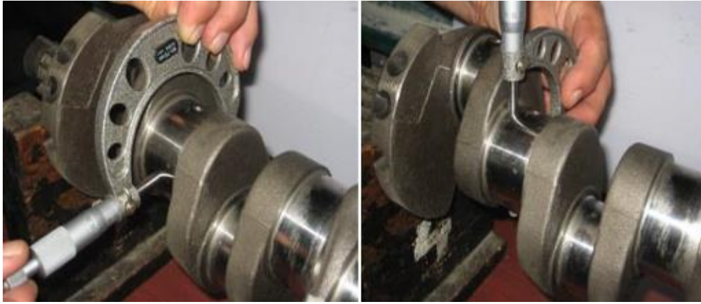
Şekil 2.6. Krank mili muylularının ölçülmesi [9].
