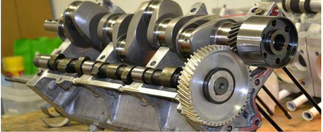
Şekil 2.2. Kam miline bağlanmış krank mili [2].
