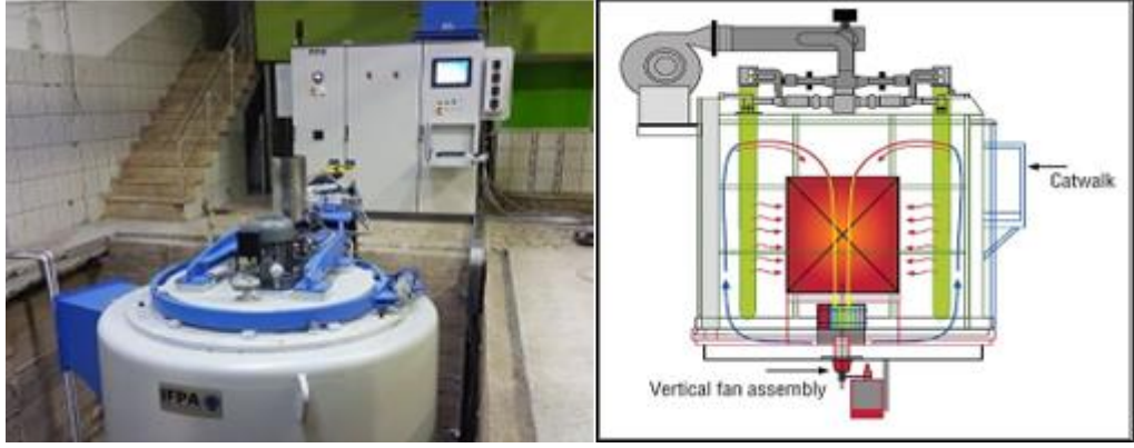
Şekil 5.1. Gaz nitrasyon fırını ve çalışma prensibi.
