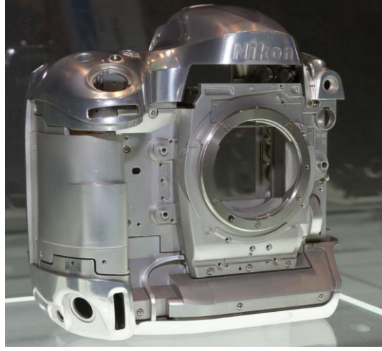
Şekil 2.14. Nikon D4 (2012) Mg alaşımı fotoğraf makinesi kasası [67].
