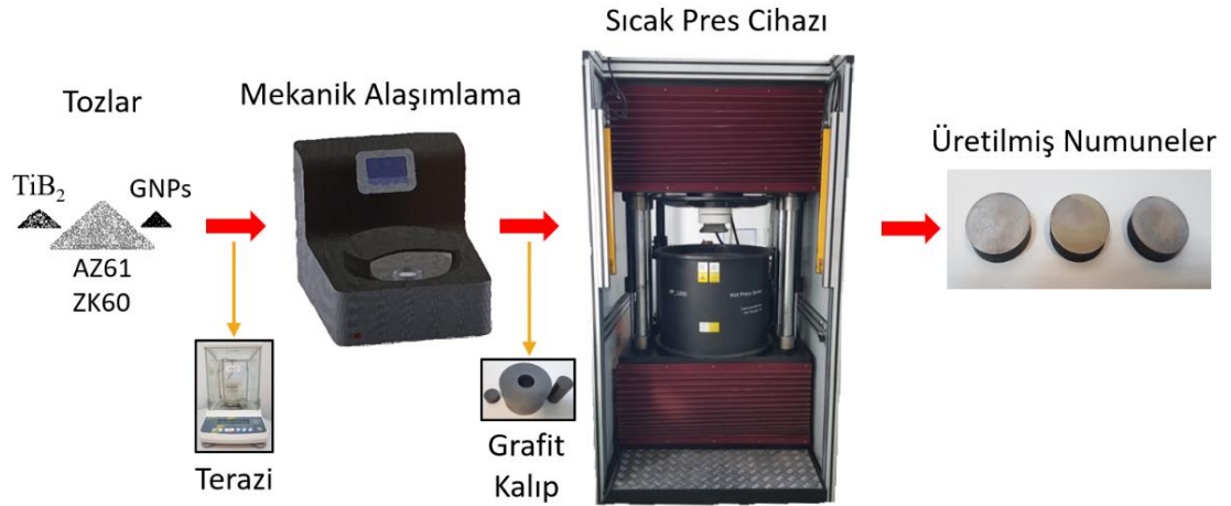
Şekil 6.2. Kompozit numunelerin üretim şeması.
