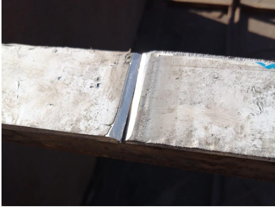
Şekil 5.2. Kaynağı yapılacak plakaların kaynak ağızı açma.
