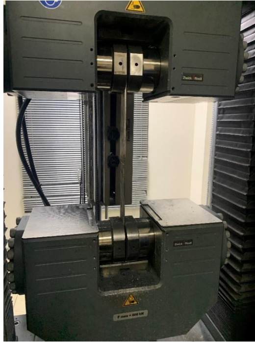
Şekil 6.1. Çekme testi anında numune kopma anı.
