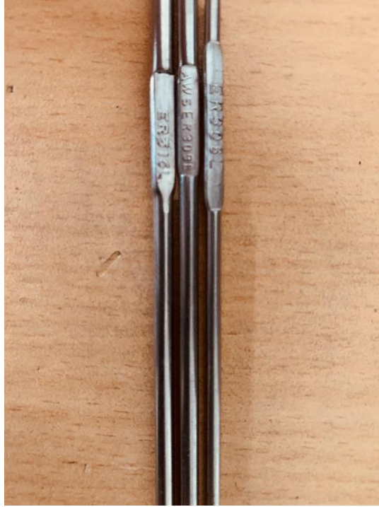
Şekil 5.3. TIG kaynağında kullanılan ilave teller.
