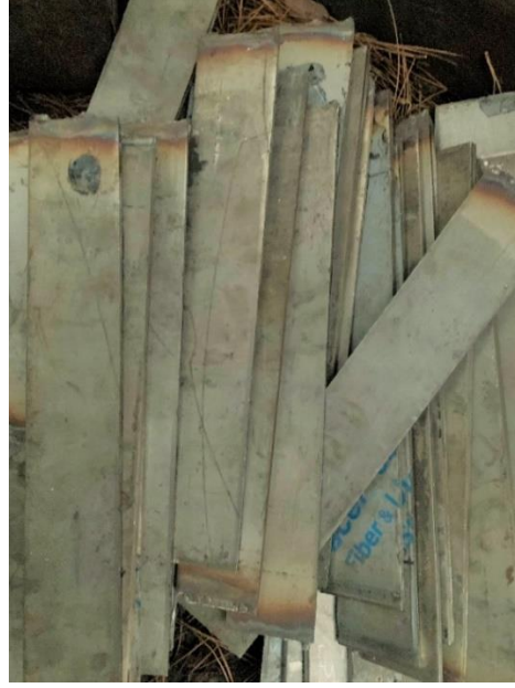
Şekil 6.2. Çekme testi sonucunda kopan parçalara ait görsel.
