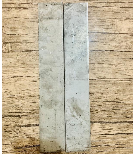
Şekil 5.1. AISI 316 kalite paslanmaz çelik numunelerin hazırlanması.
