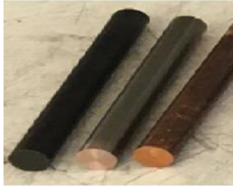
Şekil 4.3. NiTi ŞHA'ların EEİ ile işlenmesinde kullanılan elektrotların ( E_1 , E_2 , E_3 ) fotoğraf görüntüsü.
