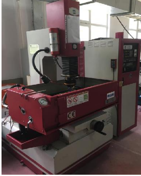
Şekil 4.1. EEI-KING ZNC K-3200 EEI Tezgahı fotoğraf görüntüsü.
