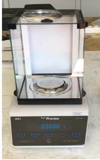
Şekil 4.4. Precisa LS 320A SCS Analitik terazi cihazı fotoğraf görüntüsü.
