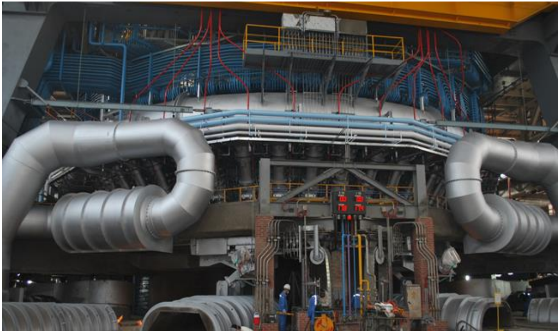
Şekil 2.3. Dünyanın en büyük yüksek fırını (6.000 m 3 ve 5.650.000 ton/yıl kapasite) Posco Gwangyang 1 no.lu yüksek fırını görseli [16].
