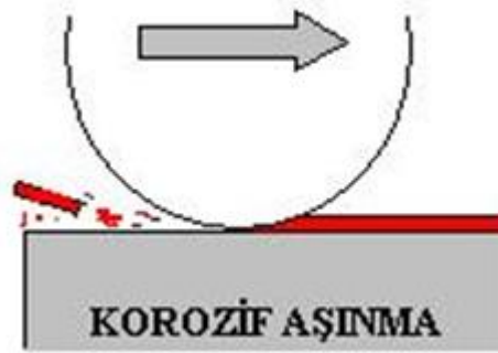
Şekil 4.6. Korozif aşınma şematik gösterimi [49].
