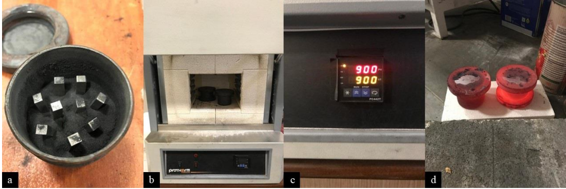
Şekil 6.4. Borlama işlemine ait görseller a) numunelerin bor tozu içerisine gömülmesi b) potaya alınan numunelerin fırına eklenmesi c) 900 °C derecede borlama d) fırından çıkan numuneler.
