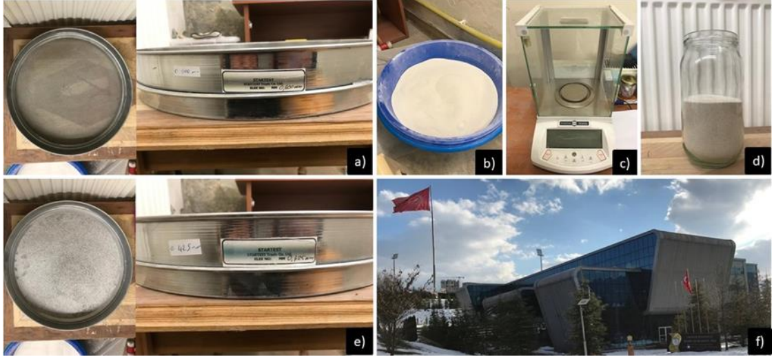
Şekil 6.8. a) 0,600 mm endüstriyel elek b) eleme işlemi sonrası elek altı kum c) 10^{-4} gram hassas terazi d) 512,5 \mu\text{m} elenmiş aşındırıcı kum e) 0,425 mm endüstriyel elek f) görüntülemelerin gerçekleştirildiği Karabük Üniversitesi Demir Çelik Enstitüsü
