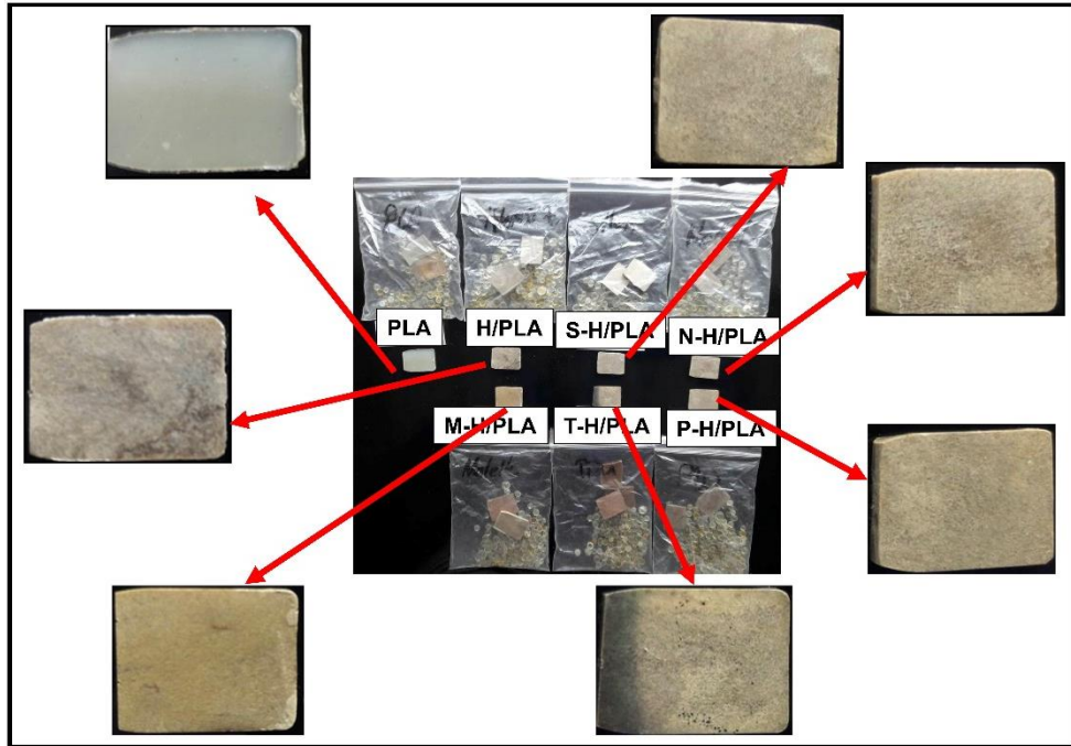
Şekil 5.26. Toprakta bozunma sonrası detaylı görünüm.
