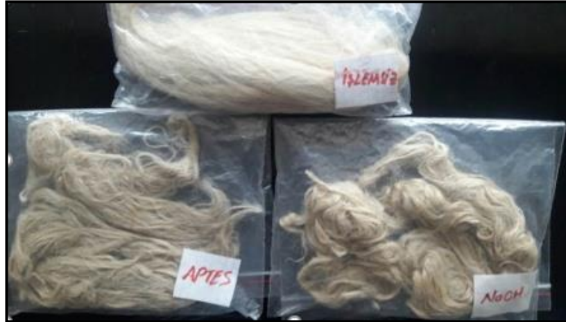
Şekil 5.2. Yüzey işlemi uygulanmamış ve uygulanmış olan elyaf görünümleri.
