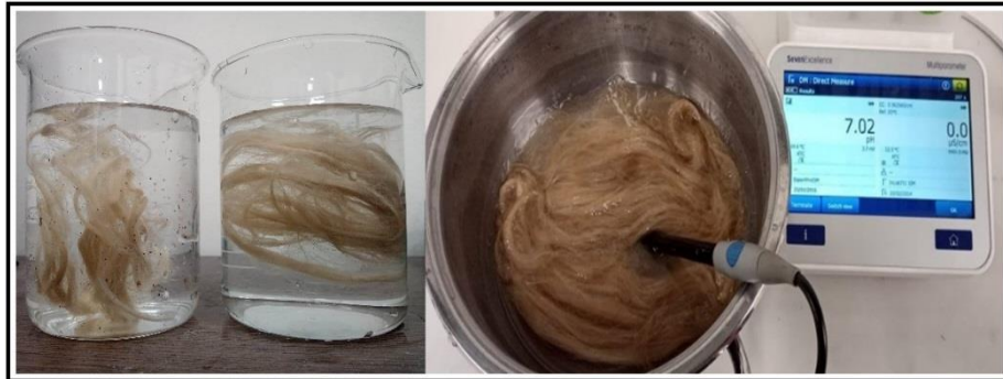
Şekil 4.4.Elyafırlara uygulanan yüzey işlemleri ve pH ayarlaması.
