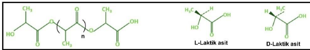
Şekil 3.2. (a) Polilaktik asidin kimyasal yapısı, (b) laktik asidin izomerleri.
