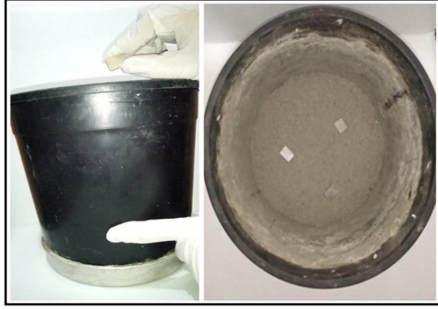
Şekil 4.16. Toprakta bozunma testinin hazırlanışı.
