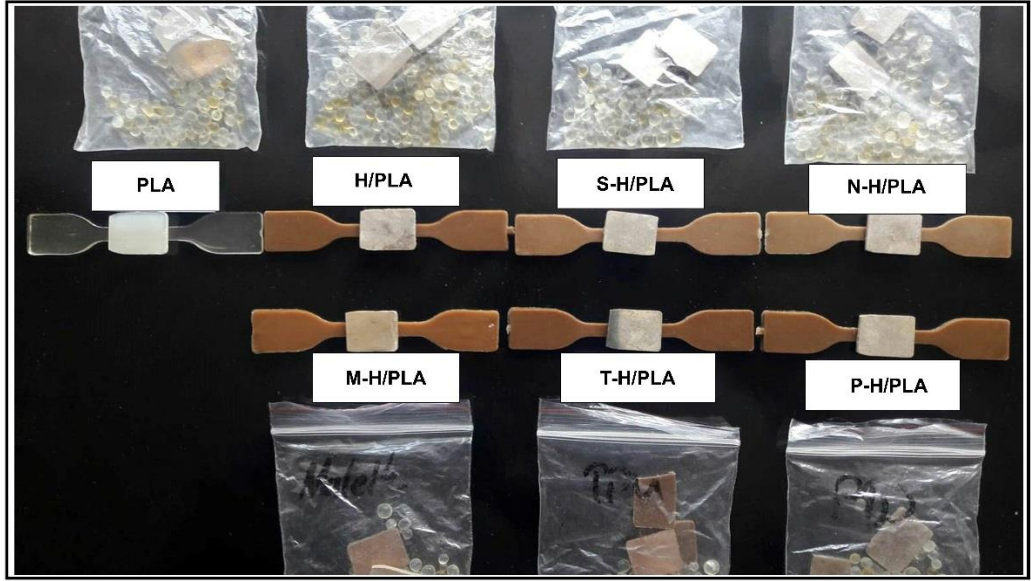
Şekil 5.25. Toprakta bozunma testi öncesi ve sonrası görünüm.
