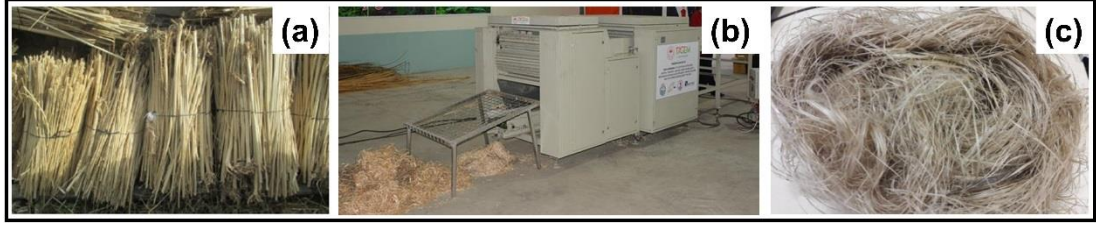
Şekil 3.9. (a) Kenevir odunsu sap elyafları [92], (b) kenevir elyafi soyma makinesi [99], (c) kenevir elyafi.
