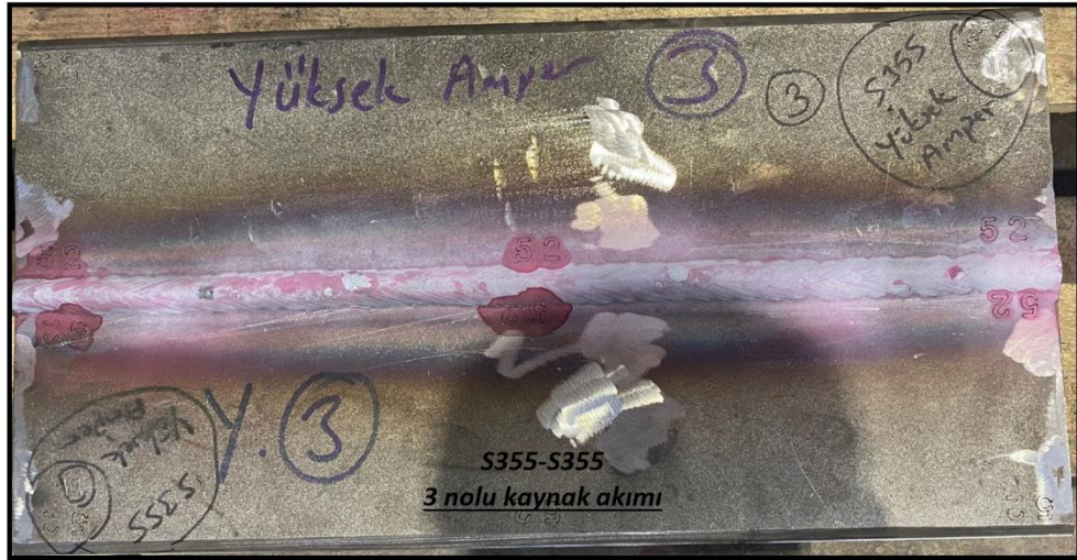
Şekil 5.15. S355-S355 3 nolu kaynak akımı ile birleştirilen numune PT görüntüsü.
