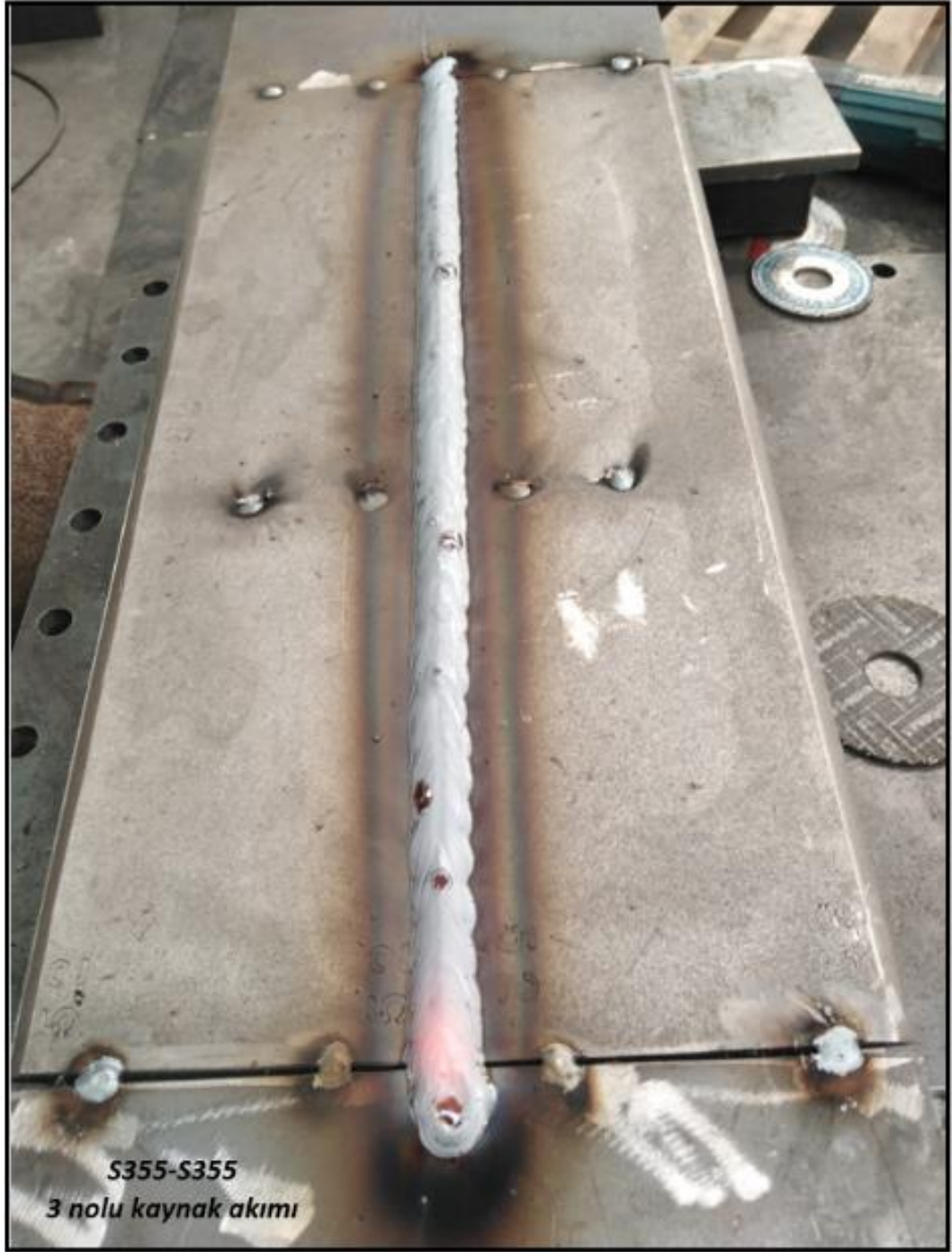
Şekil 5.6. S355-S355 3 nolu kaynak akımı kullanılarak birleştirilmiş levha görüntüsü.
