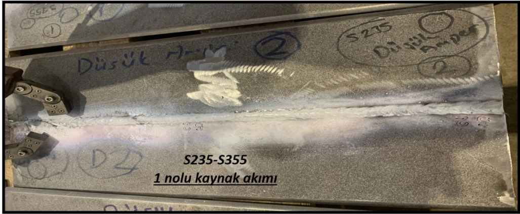
Şekil 5.28. S235-S355 1 nolu kaynak akımı ile birleştirilen numune MT görüntüsü.
