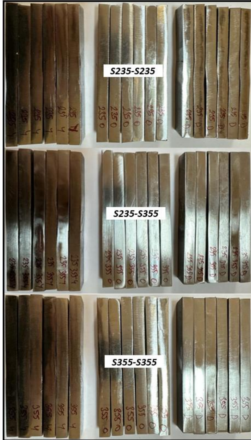
Şekil 4.21. Eğme testi numuneleri görseli.
