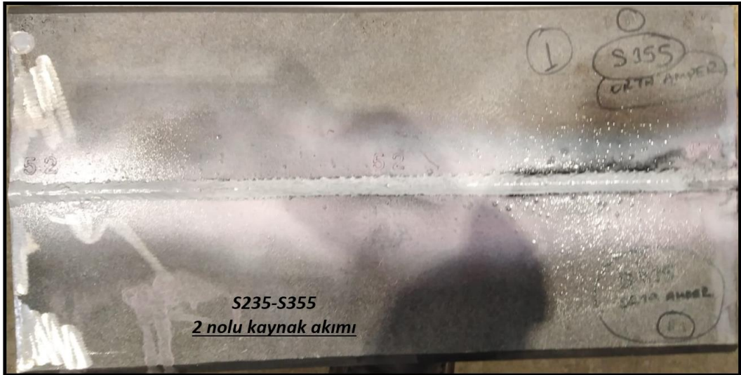
Şekil 5.29. S235-S355 2 nolu kaynak akımı ile birleştirilen numune MT görüntüsü.
