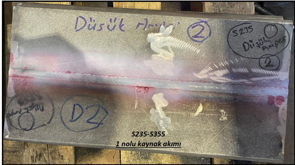
Şekil 5.10. S235-S355 1 nolu kaynak akımı ile birleştirilen numune PT görüntüsü.
