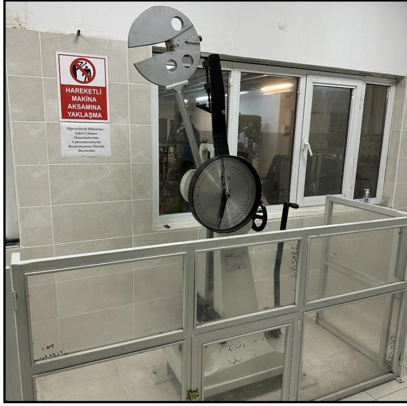
Şekil 4.23. Çentik darbe test cihazı görseli.
