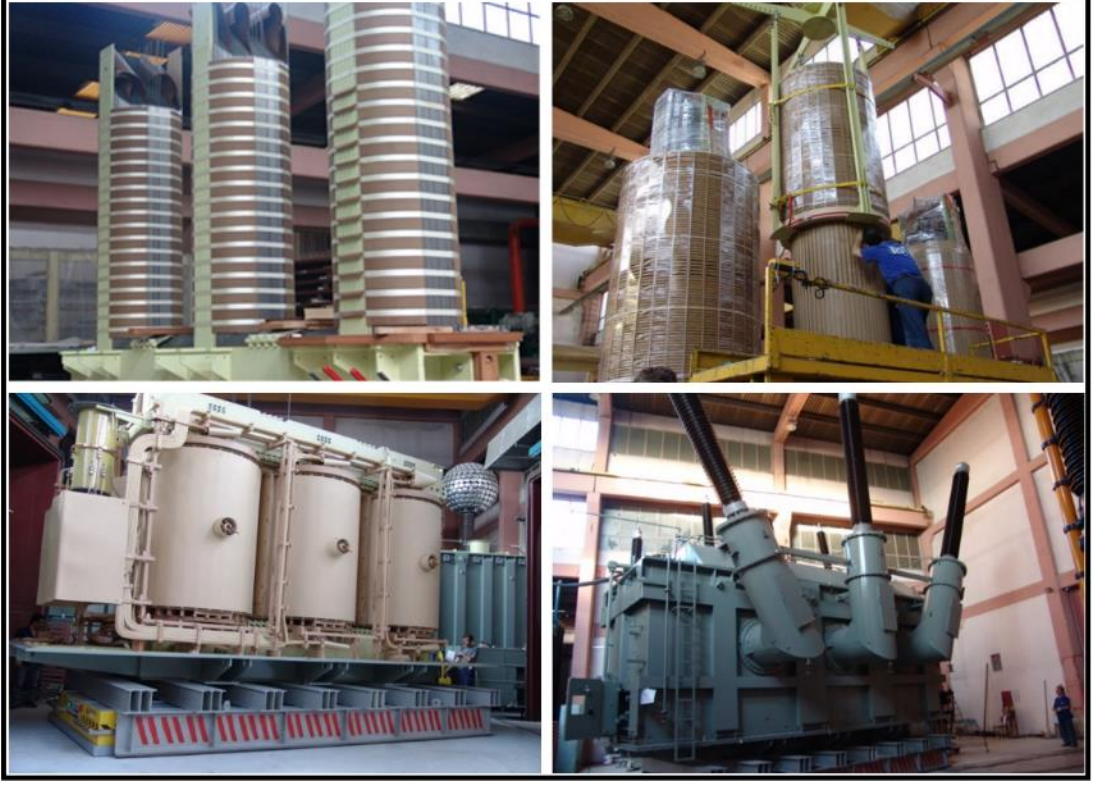
Şekil 2.5. Transformatör üretim aşamaları.
