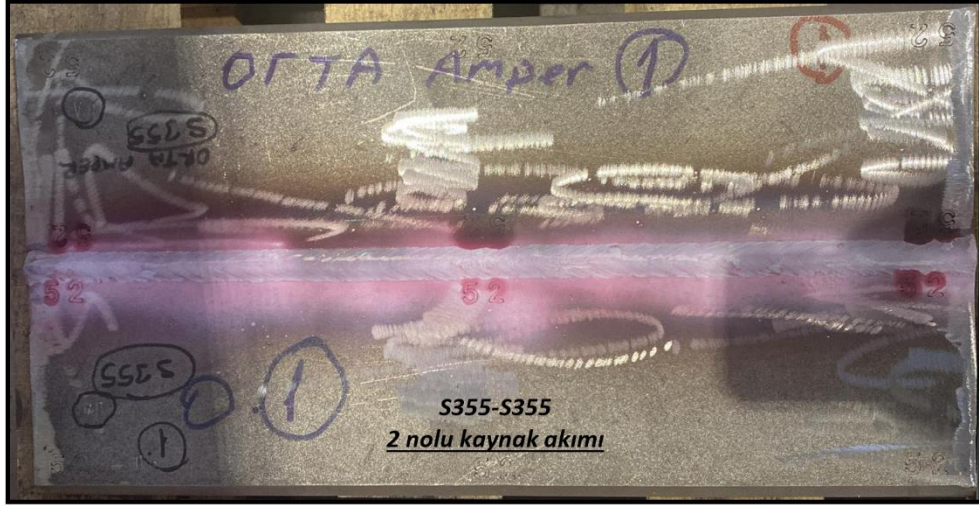
Şekil 5.14. S355-S355 2 nolu kaynak akımı ile birleştirilen numune PT görüntüsü.
