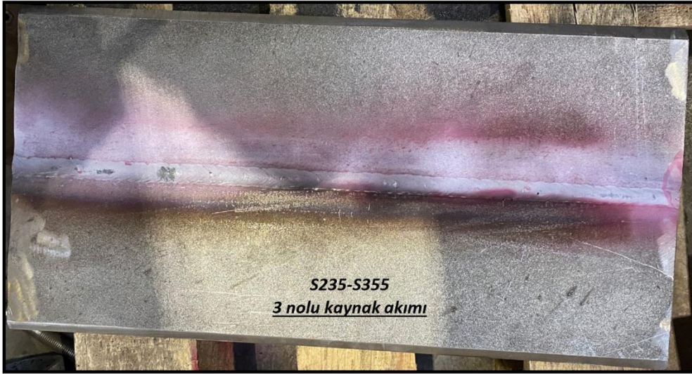
Şekil 5.12. S235-S355 3 nolu kaynak akımı ile birleştirilen numune PT görüntüsü.
