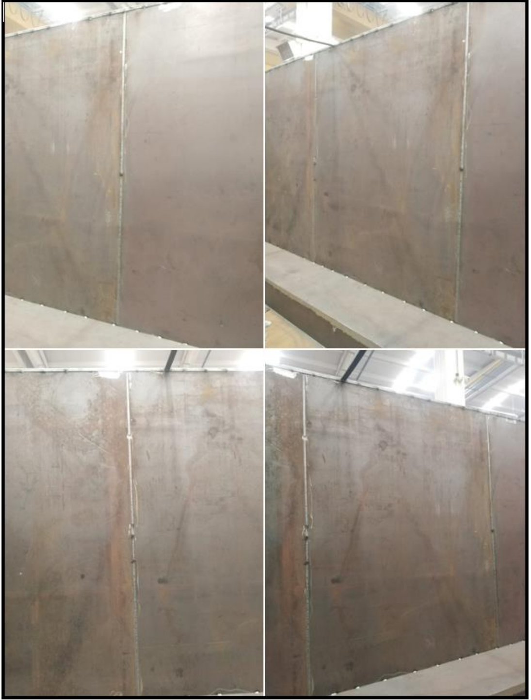
Şekil 2.6. Transformatör kazan duvar üretimi görüntüsü.
