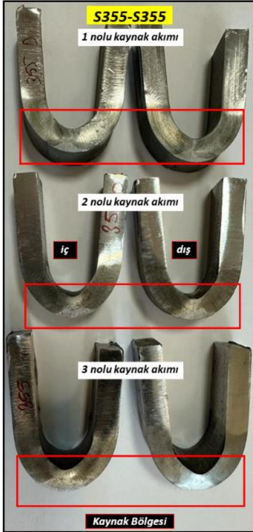
Şekil 5.62. S355-S355 kaynaklı numunelerin eğme testi sonrası görüntüleri.
