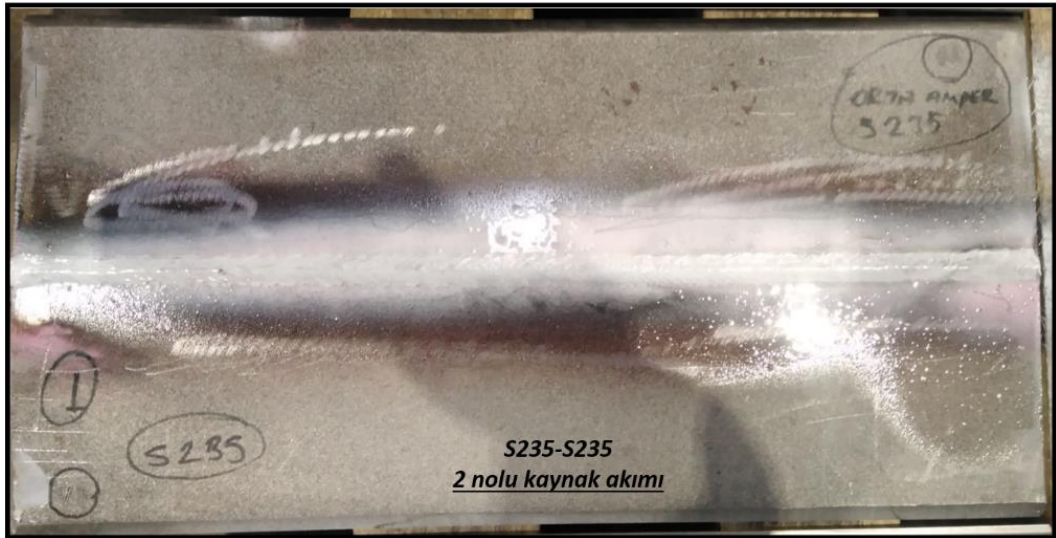
Şekil 5.26. S235-S235 2 nolu kaynak akımı ile birleştirilen numune MT görüntüsü.
