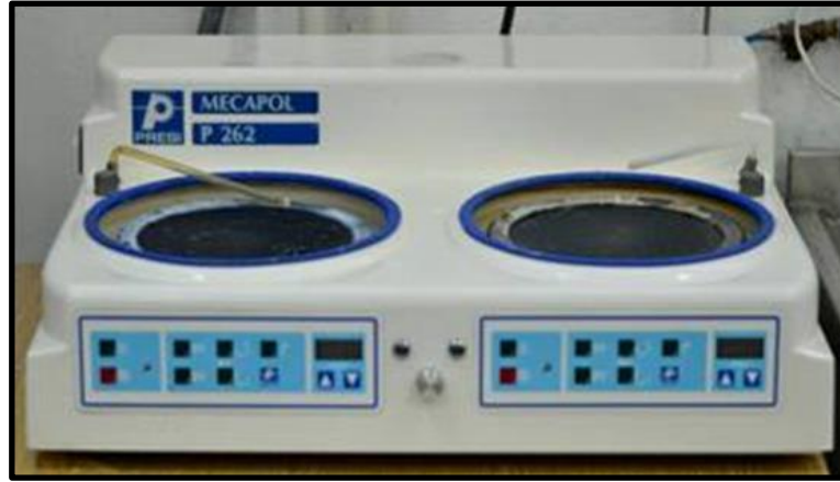
Şekil 4.16. Zımparalama ve parlatma işlemlerinde kullanılan cihaz görseli.
