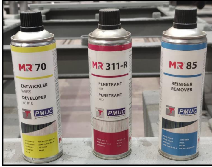
Şekil 4.14. PT yönteminde kullanılan ürünlerin görseli.
