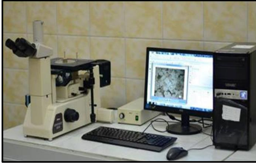
Şekil 4.17. Mikroyapı işlemlerinde kullanılan mikroskop.
