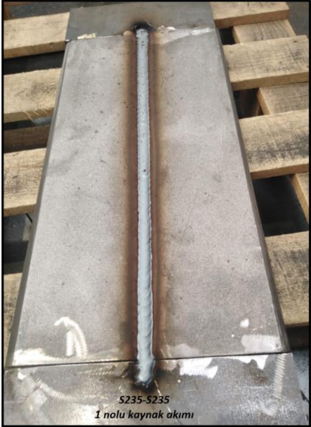
Şekil 5.1. S235-S235 1 nolu kaynak akımı kullanılarak birleştirilmiş levha görüntüsü.
