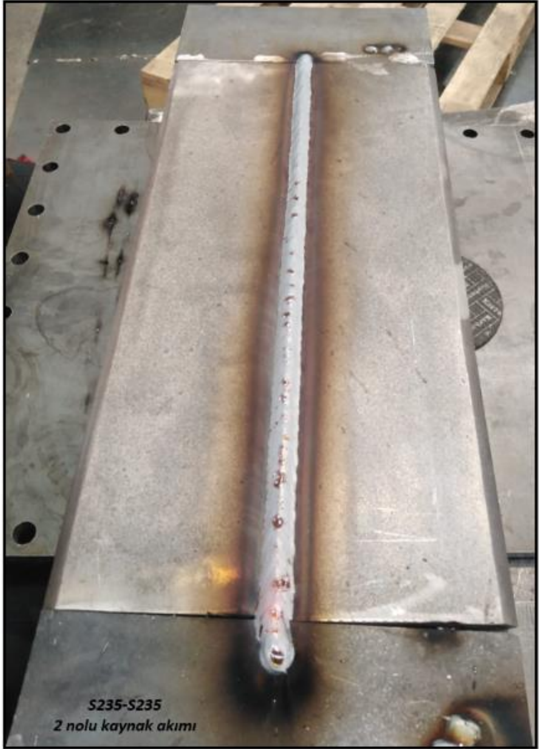
Şekil 5.3. S235-S235 2 nolu kaynak akımı kullanılarak birleştirilmiş levha görüntüsü.
