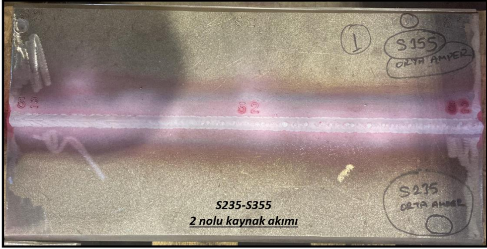
Şekil 5.11. S235-S355 2 nolu kaynak akımı ile birleştirilen numune PT görüntüsü.
