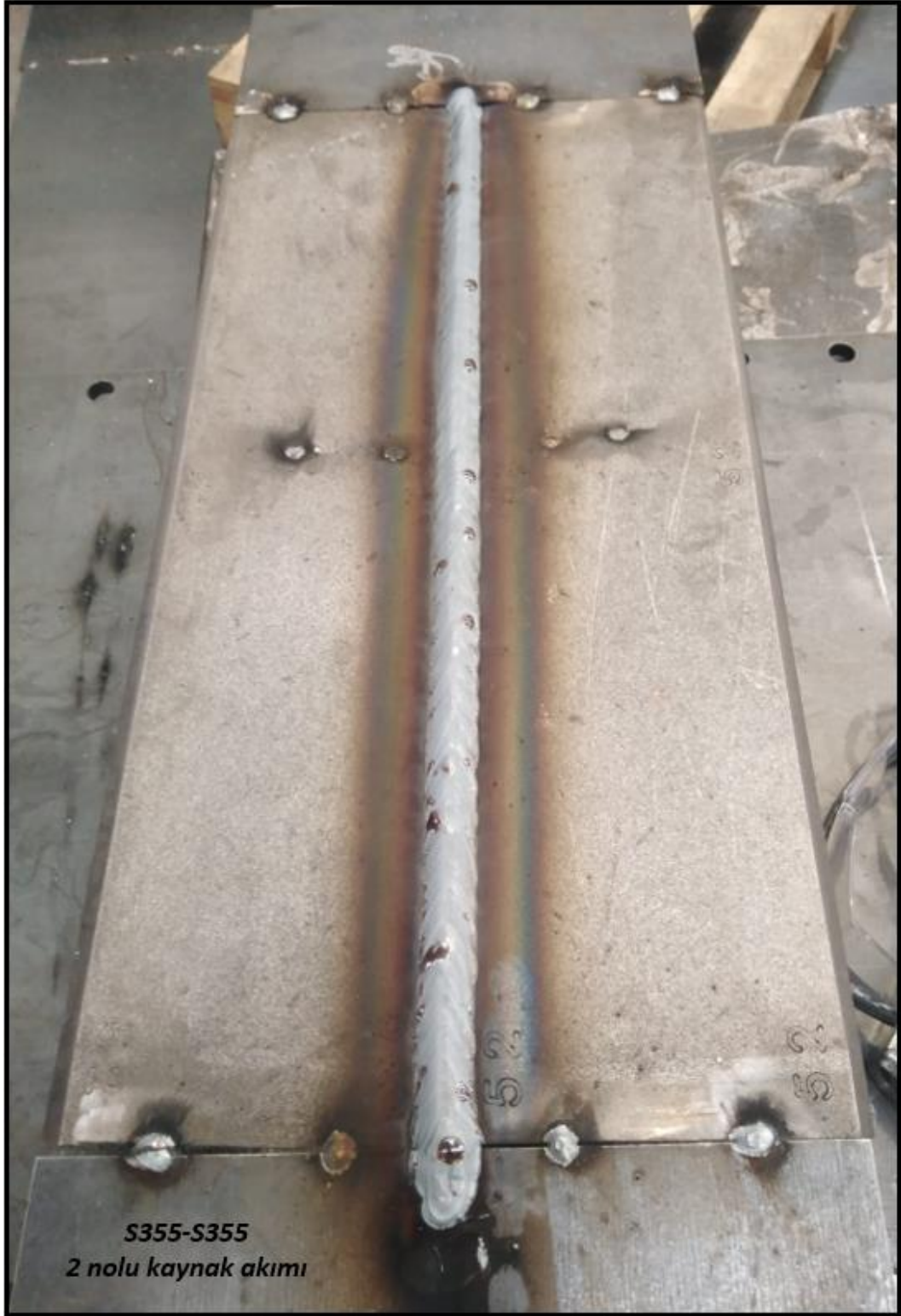
Şekil 5.4. S355-S355 2 nolu kaynak akımı kullanılarak birleştirilmiş levha görüntüsü.
