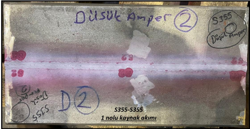
Şekil 5.13. S355-S355 1 nolu kaynak akımı ile birleştirilen numune PT görüntüsü.
