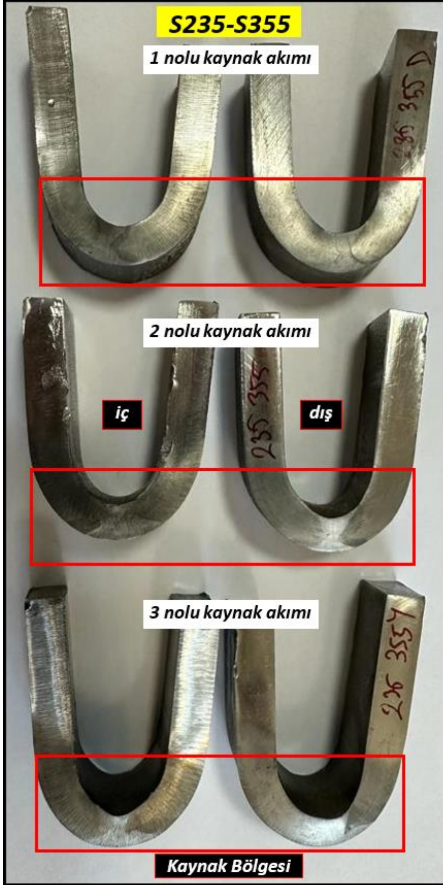
Şekil 5.61. S235-S355 kaynaklı numunelerin eğme testi sonrası görüntüleri.
