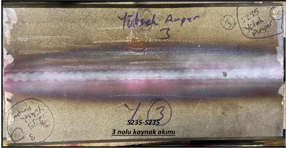
Şekil 5.9. S235-S235 3 nolu kaynak akımı ile birleştirilen numune PT görüntüsü.
