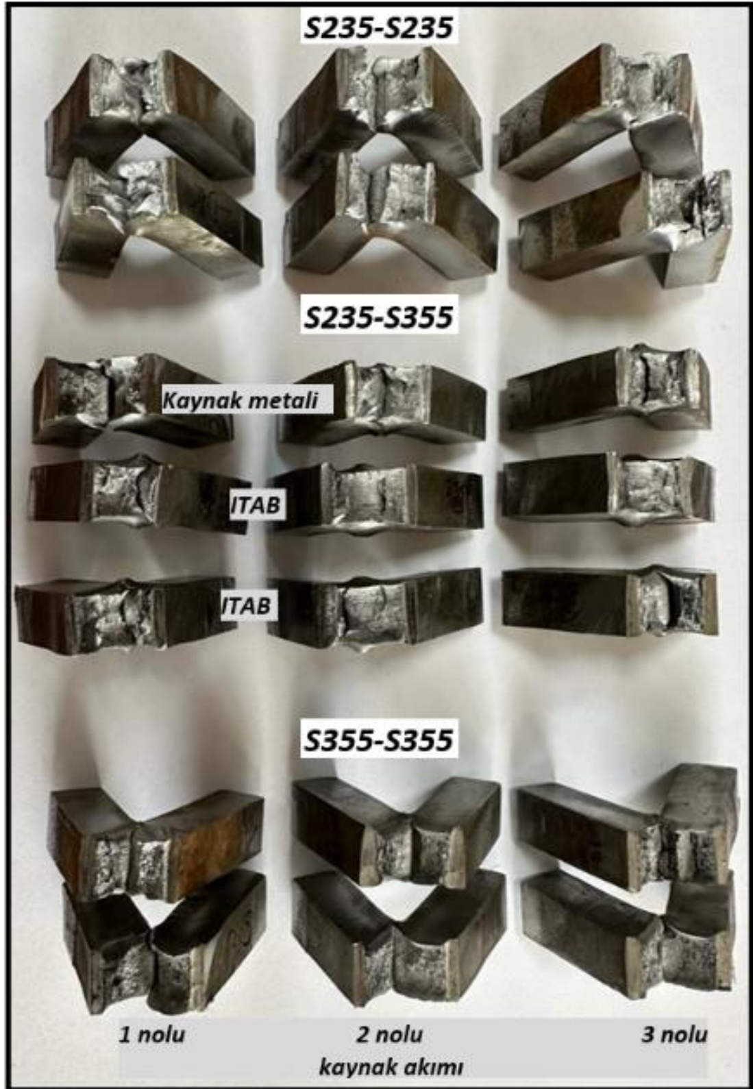
Şekil 5.64. Kaynaklı numunelerin çentik darbe testi sonrası görüntüsü.
