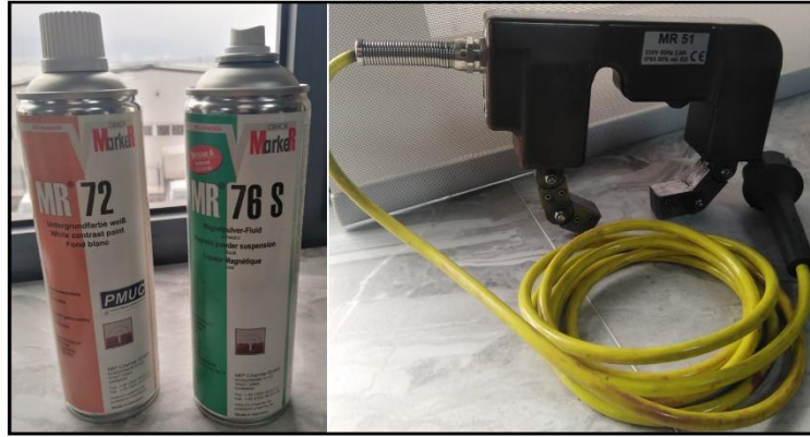
Şekil 4.15. RT yönteminde kullanılan cihaz ve manyetik toz görseli.
