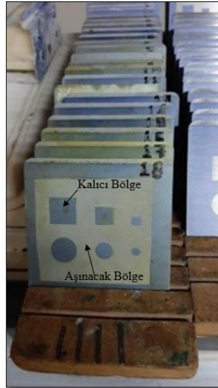
Şekil .36. Banyolama işlemi tamamlanan iş parçası numune görüntüleri.
