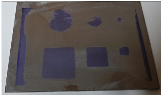
Şekil .28. Kirlili yüzeye uygulanan kaplama görüntüsü.
