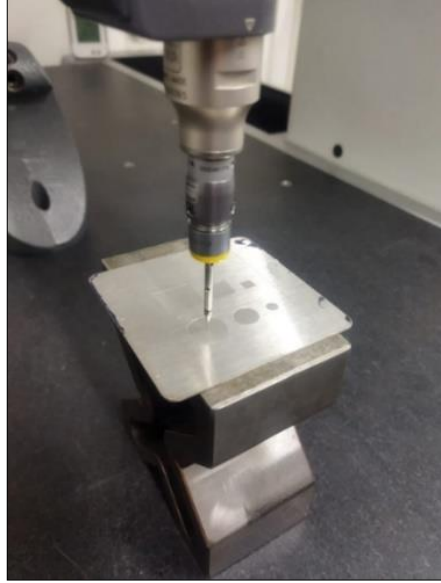
Şekil .44. PCM makina ile AISI 304 iş parçası numunesi aşındırma işlemi sonrası elde edilen aşınma derinliğinin CMM cihazı ile ölçümü
