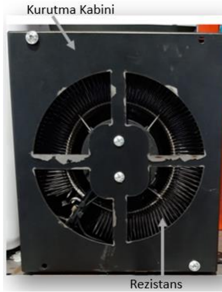
Şekil .23. PCM makinesi kurutma ünitesi görüntüsü.
