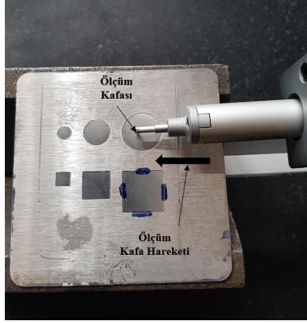
Şekil .49. Yüzey pürüzlülüğü ölçüm görüntüsü.
