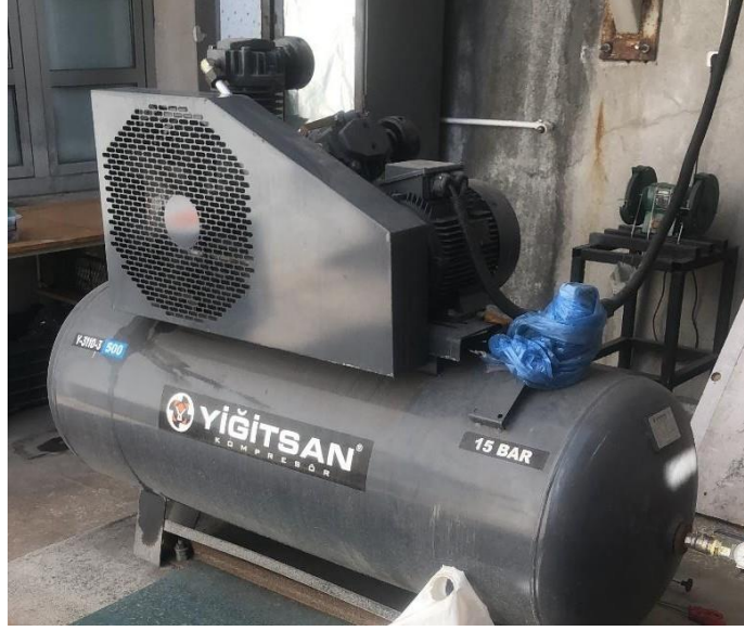
Şekil 3. 7. HS-KT ısıtım sisteminde kullanılan kompresör.
