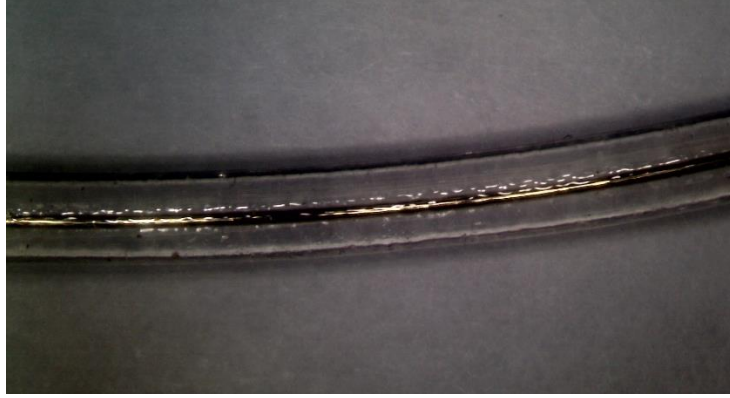
Şekil 4.11. Filament ekseninde telin konumu.
