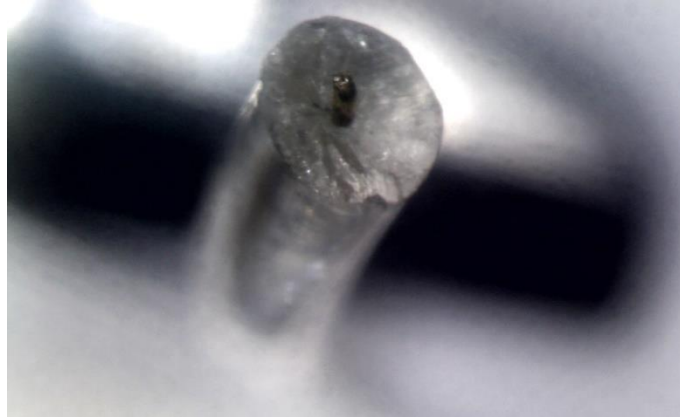
Şekil 4.12. Filament çap kesitinde telin konumu.
