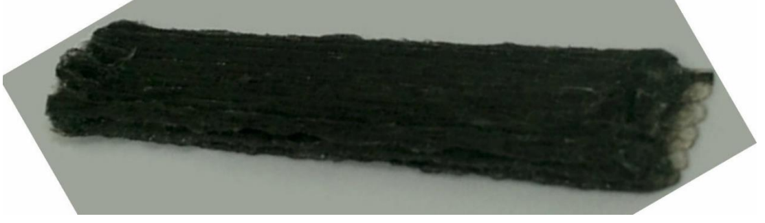
Şekil 3.9. Yazdırılan karbon fiber eğilme numunesi [29].
