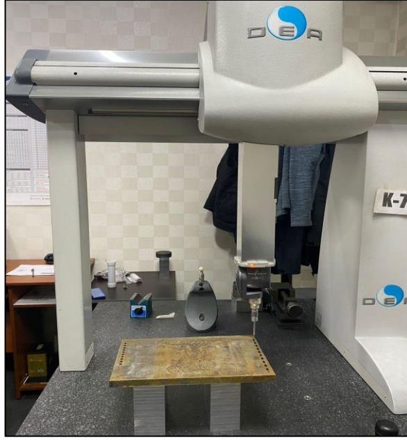
Şekil 5.9. Dikdörtgen kesitin ölçüm tamlığının CMM’de incelenmesi.
