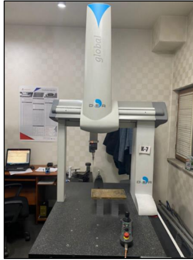
Şekil 5.4. Ölçüm tamlığı belirlenirken kullanılan CMM'in genel görüntüsü.
