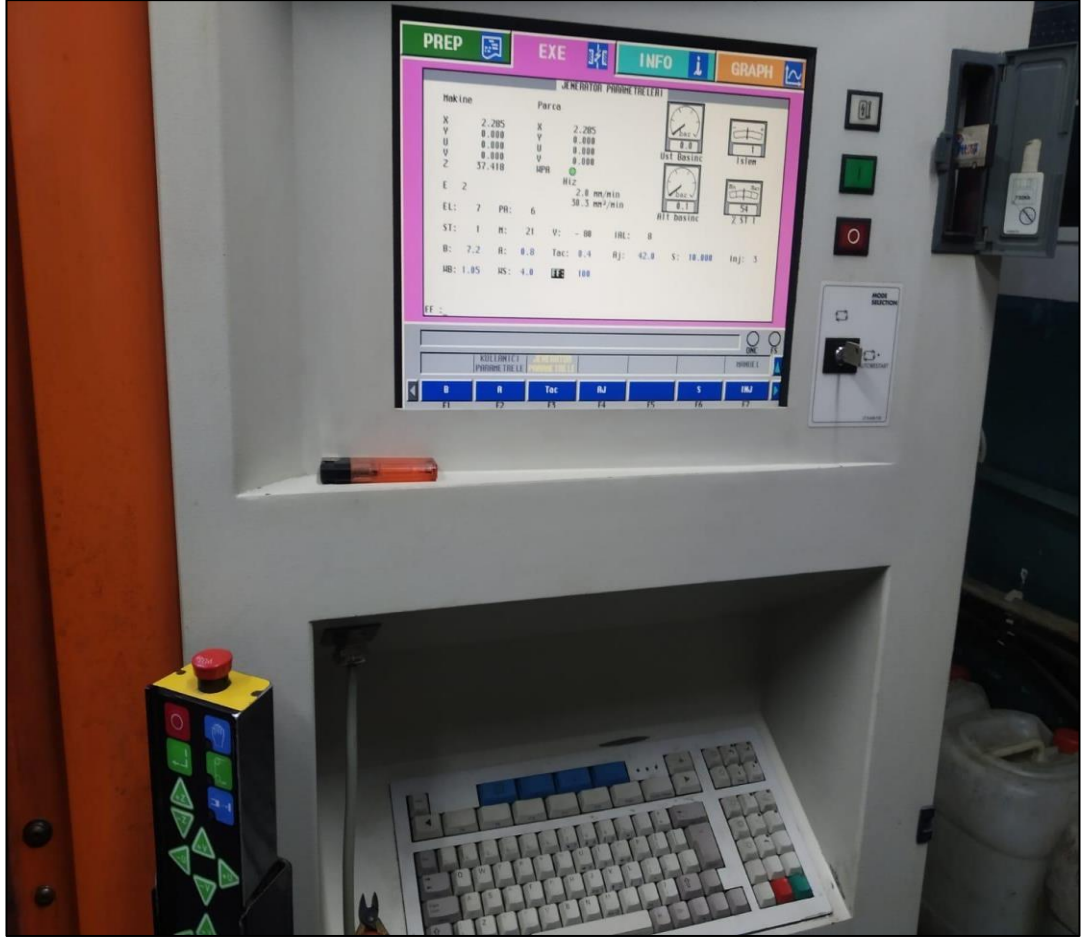
Şekil 5.12. Tel erozyon tezgahında parametrelerin görüldüğü ekran.
