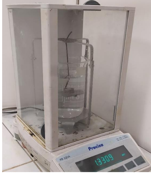
Şekil 5.4. Hazırlanan numunenin sudaki ağırlığının hassas terazide ölçümü.
