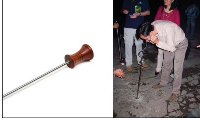
Şekil 1.1. Dinleme çubuğu (Muhammetoğlu, H. ve Muhammetoğlu, A., 2017)
