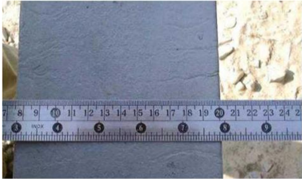
Şekil 2.13. Kum püskürtülmüş kütük üzerindeki enine çatlağın görünümü [3].
