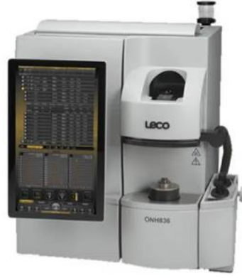
Şekil 5.1. LECO ONH 836 marka elementel analiz cihazı.
