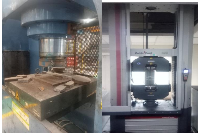
Şekil 5.4. (a) load cell içermeyen ve (b) load cell içeren basma test cihazlarının görünümü.
