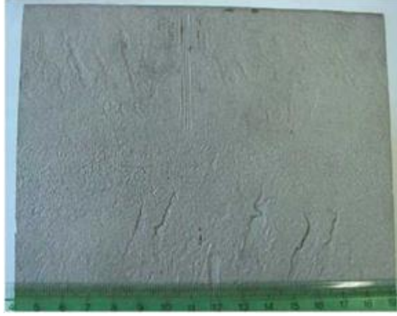
Şekil 2.3. Kum püskürtme sonrası düşük karbonlu çelik kütük yüzeyi [2].
