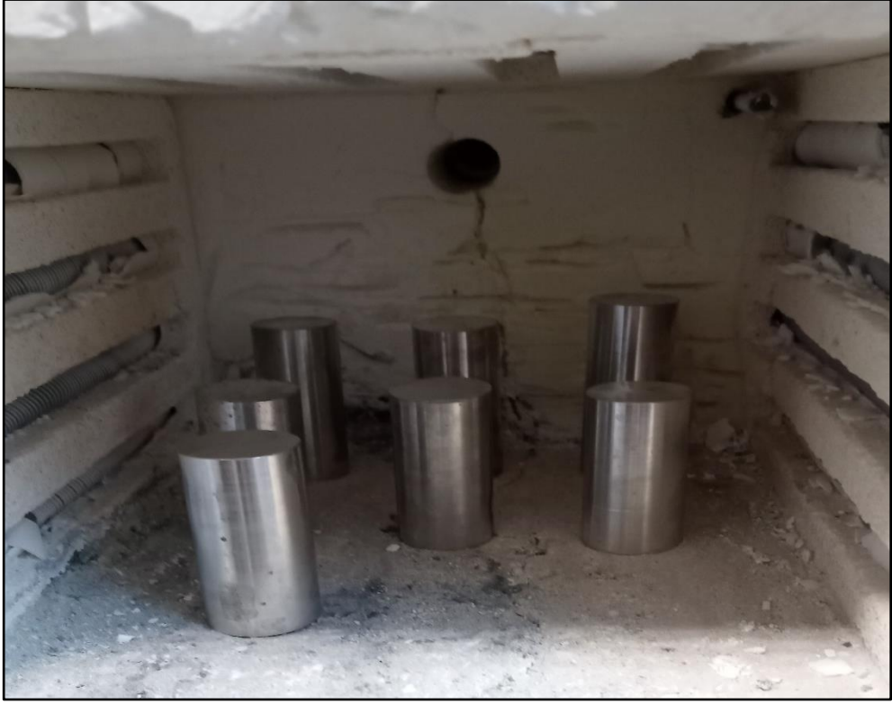
Şekil 3.6. Sıcak ekstrüzyon öncesi biyetlerin fırında ön ısıtması.
