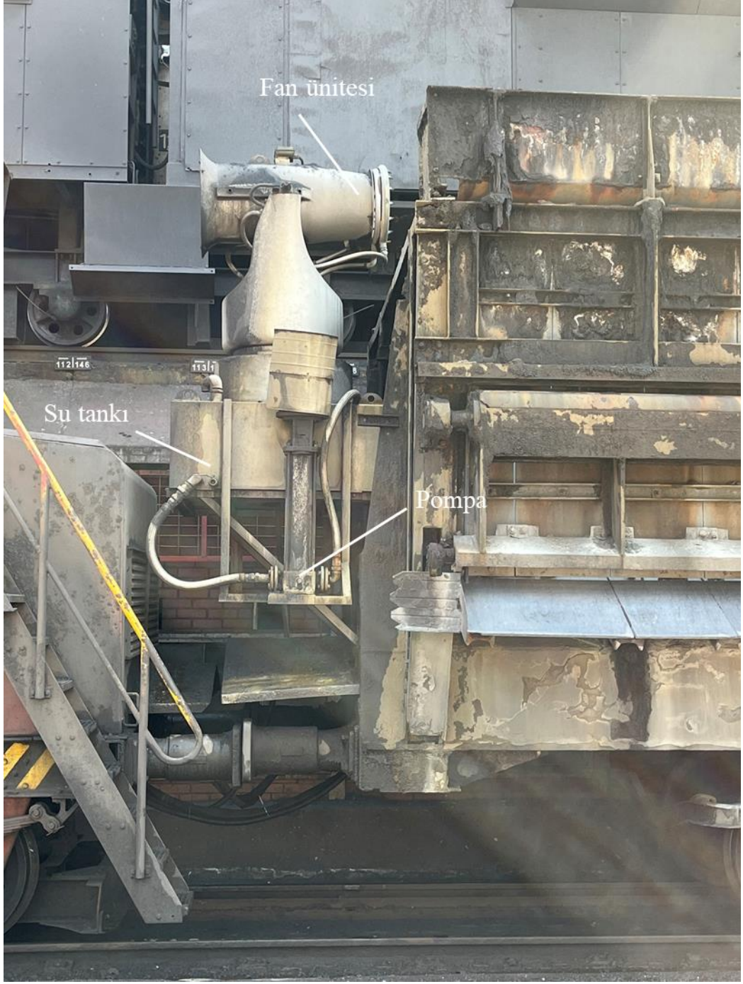
Şekil 4.11. Lokomotif tarafı fanlı toz bastırma sistemi genel görüntüsü.
