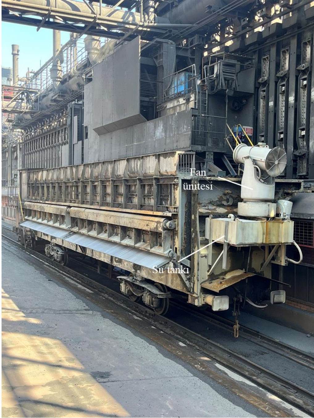
Şekil 4.12. Uç taraf fanlı toz bastırma sistemi genel görüntüsü.
