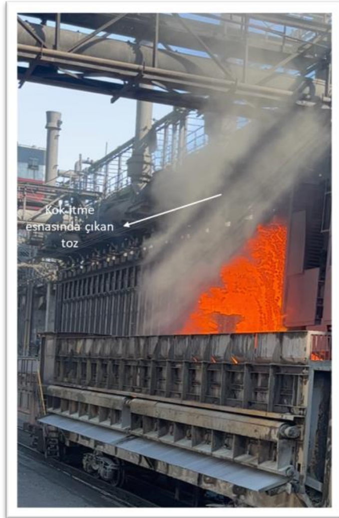
Şekil 4.1. Kardemir kok bataryalarında kok itme esnasında havaya çıkan toz.
