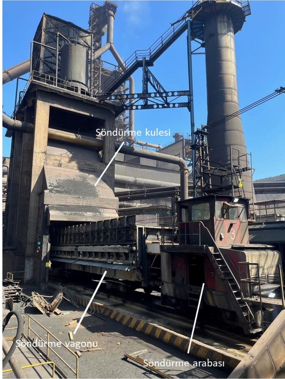
Şekil 2.21. Söndürme vagonunun söndürme kulesine girdiği ana ait bir görsel.
