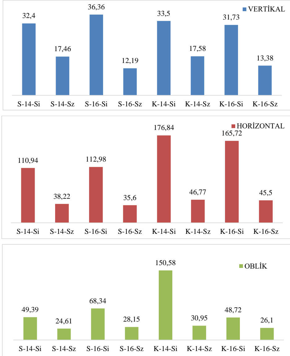
Şekil 4.56. İmplantta meydana gelen maksimum von Mises gerilmesi (MPa).
