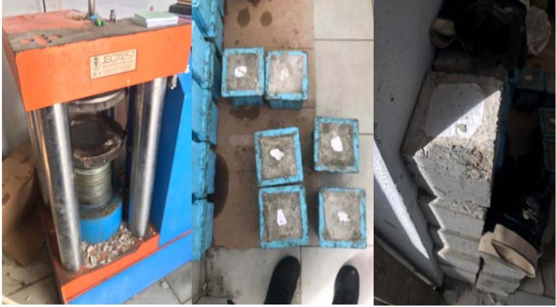
Şekil 2.13. Beton Test Presi ve farklı marka beton test kutuları örnekleri [38].
