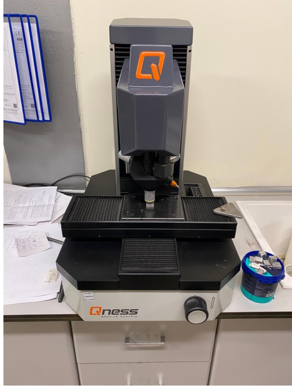
Şekil 4. 15. QNESS Q250M marka mikro makro sertlik ölçüm cihazı
