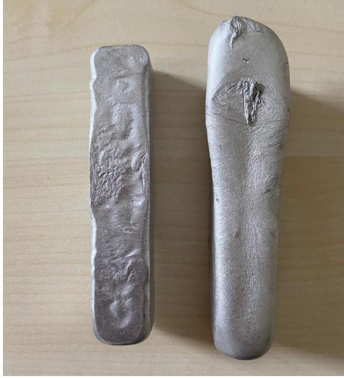
Şekil 4. 12. Ergimiş metal karıştırma döküm yöntemiyle üretilen yarı mamul MAK numuneye ait görüntü
