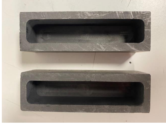
Şekil 4. 8. MAK üretiminde kullanılan kalıpların genel görünümü
