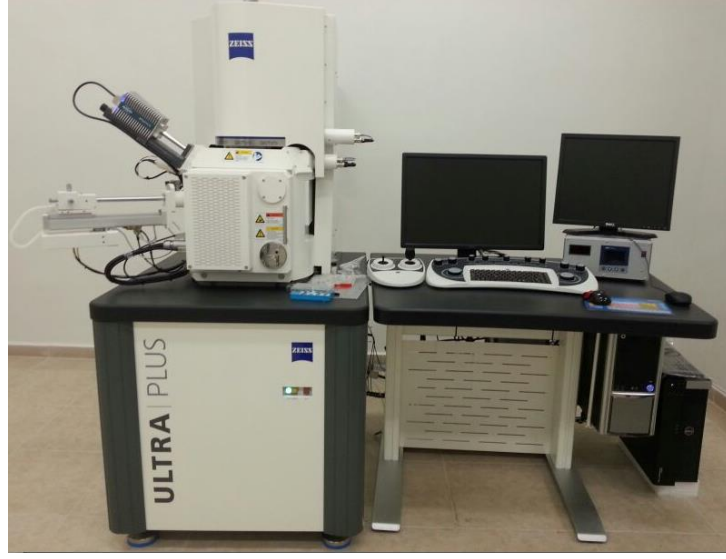
Şekil 4. 14. Carl zeiss ultra plus gemini fesem SEM ve EDX cihazı
