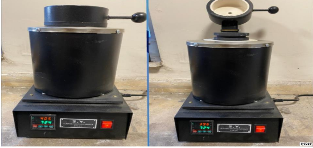
Şekil 4. 3. Üretiminde kullanılan karıştırma döküm ısıtma cihazı genel görünümü.
