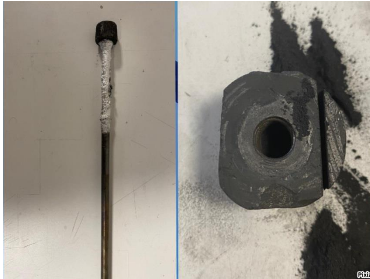
Şekil 4. 7. Grafit malzemedeki yapılmış karıştırıcı.
