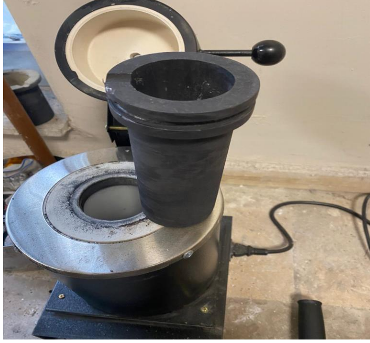
Şekil.4. 4. Karıştırma döküm yönteminde kullanılan grafit malzemenen yapılmış potanın görüntüsü
