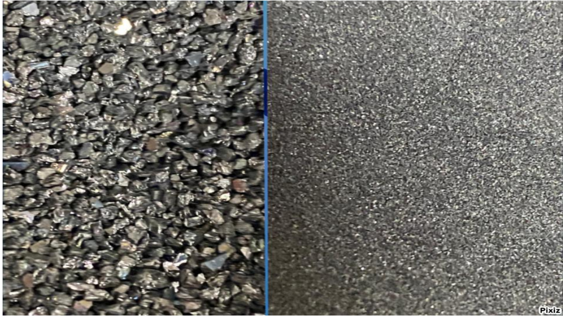
Şekil 4. 1. 375 \mu m ve 75 \mu m ortama boyuta sahip parçacıklar.
