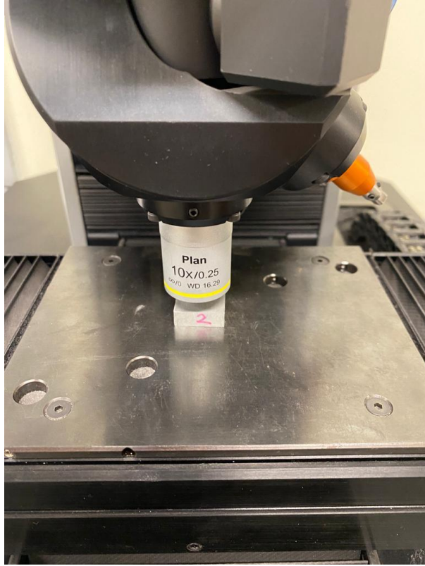
Şekil 4. 16. QNESS Q250M marka mikro makro sertlik ölçüm cihazı
