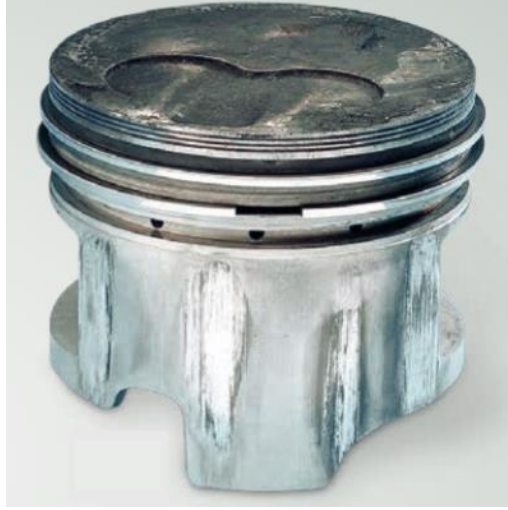
Şekil 0.12. Piston eteklerinde görülen sürtünme aşınması [76].
