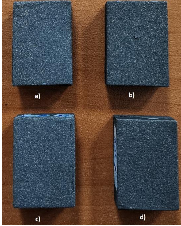
Şekil 0.4. Kaplanmış numuneler; a) A380 kalın, b)A380 ince, c) A380 kalın, d) A380 ince
