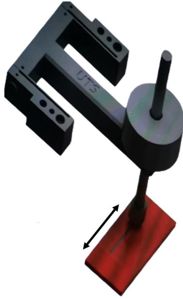
Şekil 0.9. Ball-on-Flat test cihazı şematığı.
