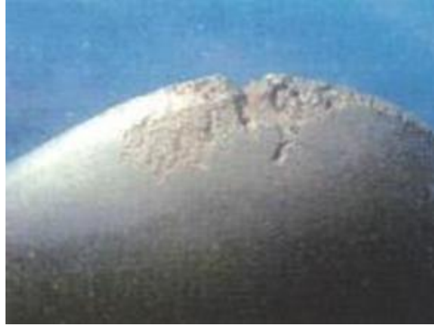
Şekil 0.17. Gemi pervanesinde gerçekleşen korozyon aşınması [79].
