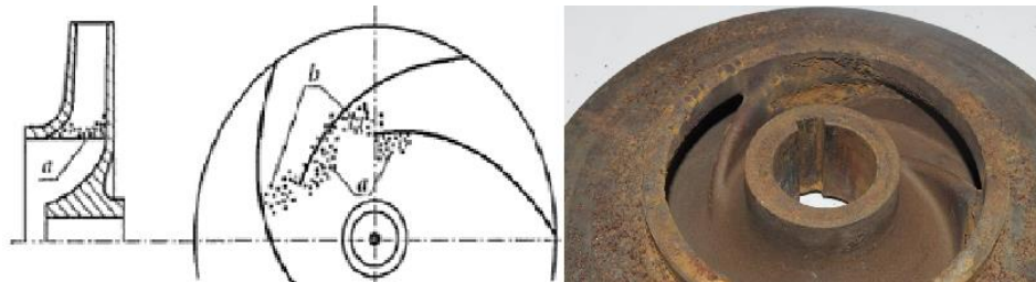
Şekil 0.16. Pompa çarkında gerçekleşen kaviteasyon [78].
