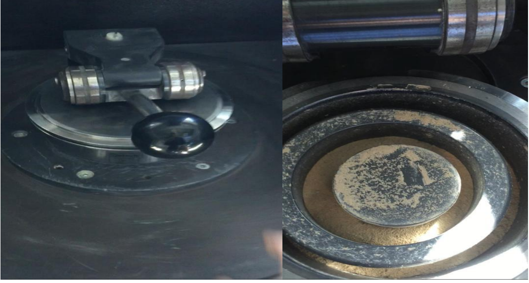
Fotoğraf 6. Titreşimli Diskli Öğütücü ile Yüksek Alaşımli Kap içerisindeki Kayaç Numunesinin Tozlaştırma işlemi
