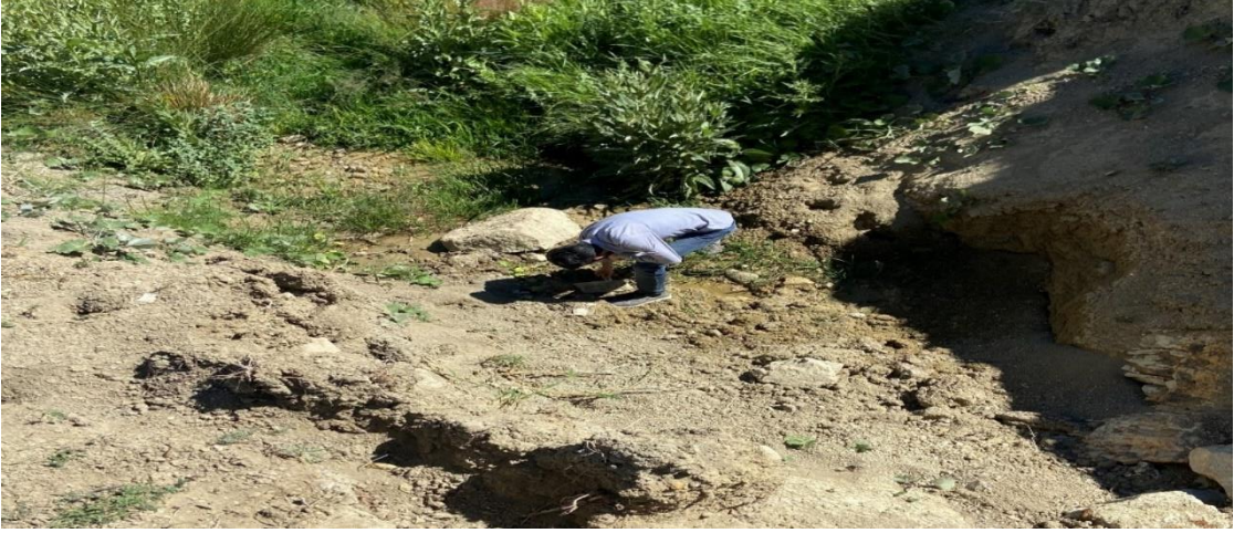
Fotoğraf 217. Sahanın Anakayasında Sızan Suyun TDS Ölçümü
