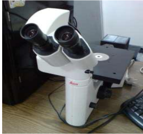
Şekil 3.8. Mikro yapı incelemelerinde kullanılacak Leica DM ILM model optik ışık mikroskobu.
