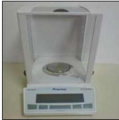
Şekil 3.4. Ağırlık kayıplarının hesaplanmasında kullanılacak Precisa marka XS220A model 0,1 mg hassasiyette elektronik terazi.
