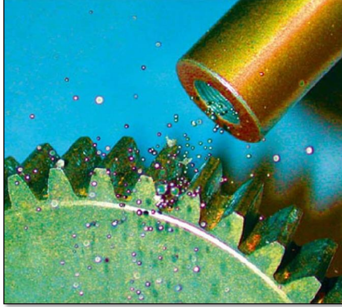
Şekil 2.12. Bir dişlinin dişlerinin bilyalı dövülmesi [12]
