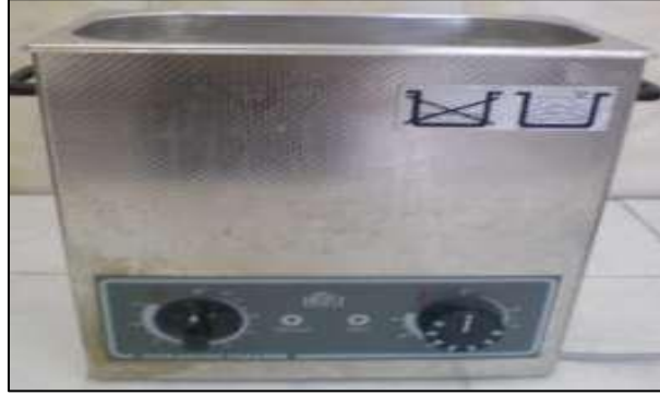
Şekil 3.3. Numune temizleme aşamasında kullanılacak MBTU marka ultrasonik temizleme cihazı
