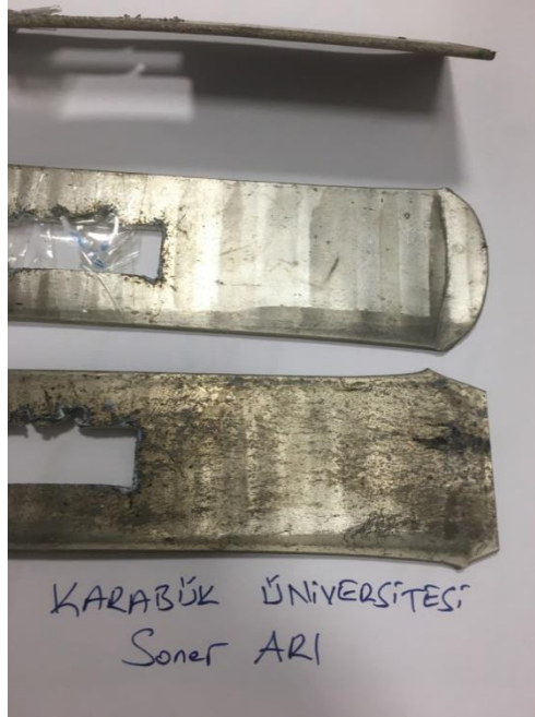
Şekil 3.2. Deneyde kullanılan numunelerin haddeleme sonrası hali.
