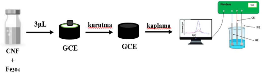
Şekil 3.2. AgNP/CNF-Fe 3 O 4 /GCE'nin hazırlanma basamaklarının şematik gösterimi
