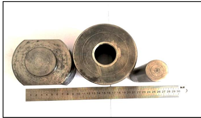
Şekil 5.3. Numunelerin preslenmesinde kullanılan kalıp ve zımba.
