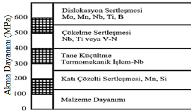
Şekil 2.18. Çeşitli dayanım arttırıcı mekanizmalarının akma dayanımına etkisi [30,90].
