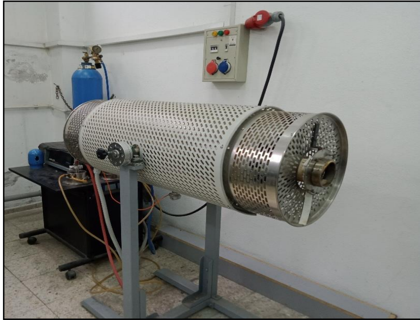
Şekil 5.4. Deneysel çalışmalarda kullanılan atmosfer kontrollü fırın.
