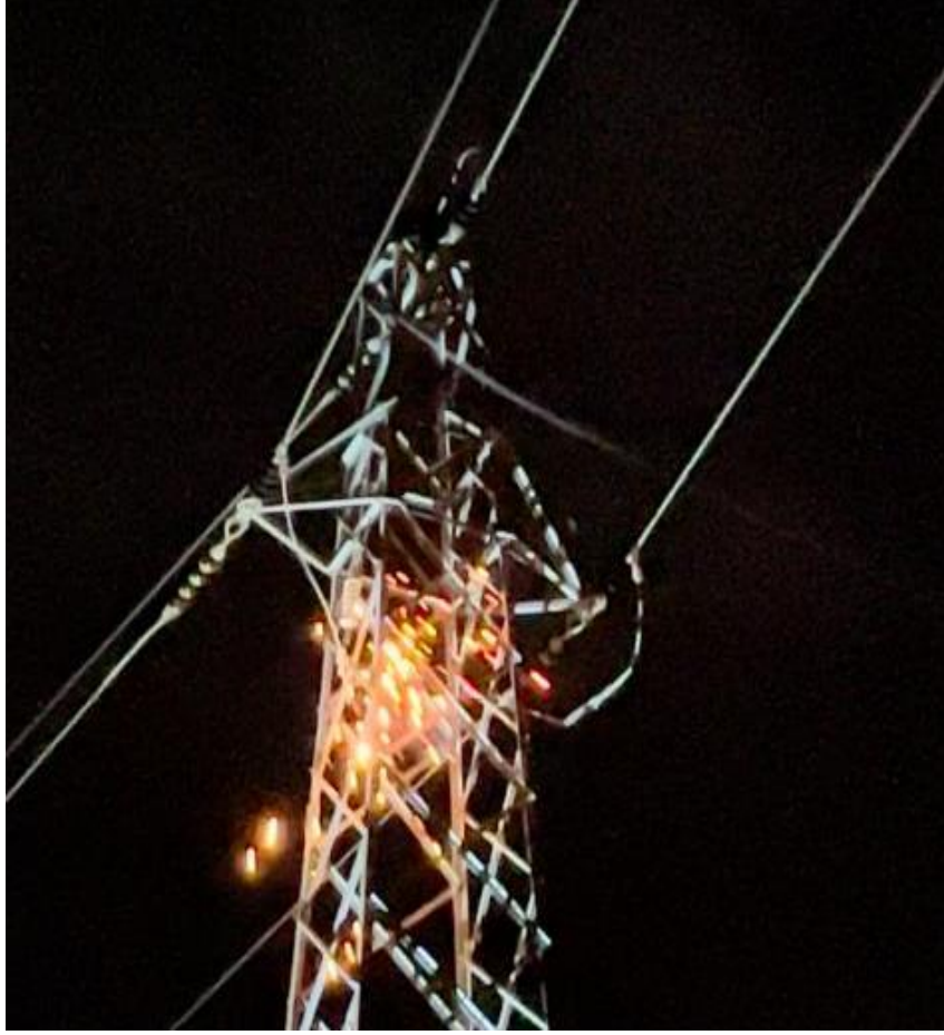
Şekil 4.23. Yapay arıza düzeneği ile faz-toprak arızası.
