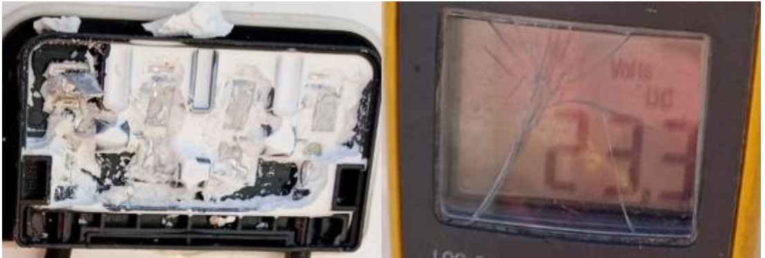
Şekil 4.12. Güneş paneli onarım öncesi bağlantı kutusu ve voltaj durumu
