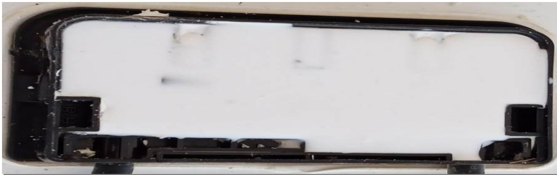
Şekil 4.14. Güneş paneli bağlantı kutusu silikonlama sonrası
