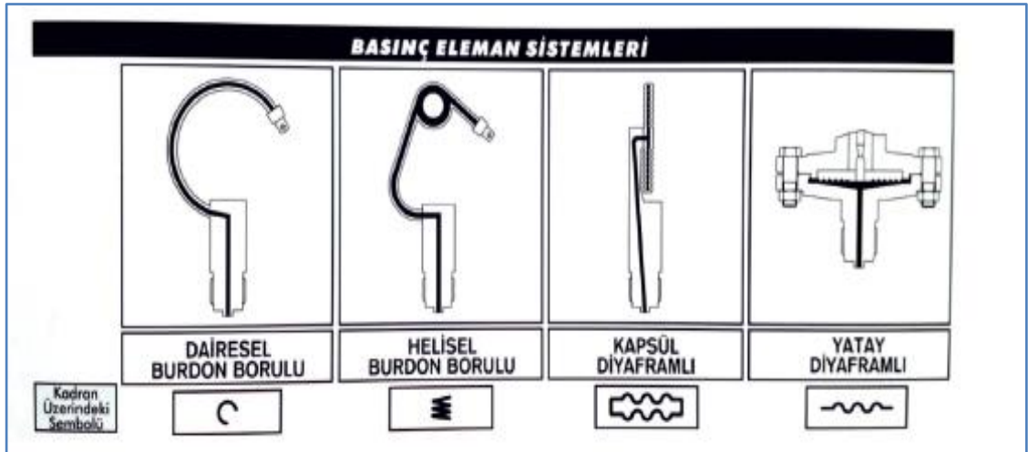
Şekil 2.4. Manometre Ölçümlerinde Kullanılan Elastik Elemanlar [2].
