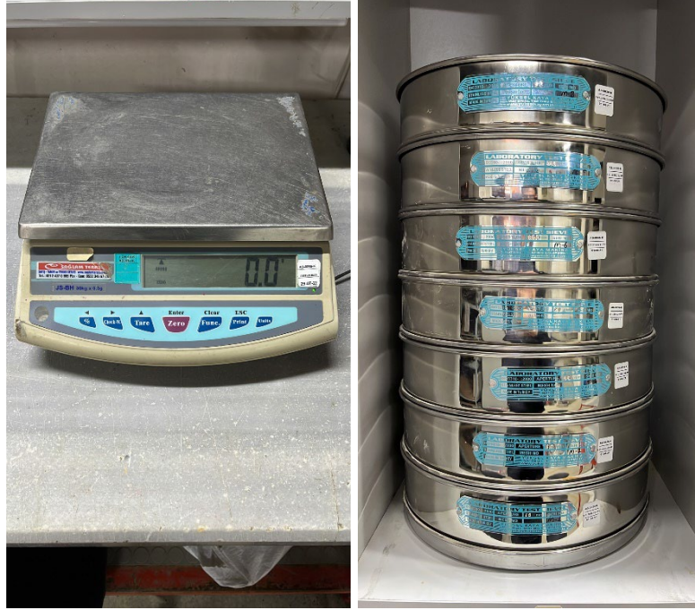
Şekil 4.5. Elektronik hassas terazi ve laboratuvar elekleri.
