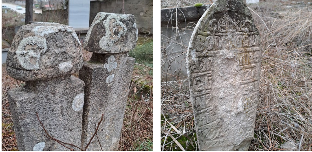
Şekil 5.5. Yazıköy mezarlığındaki mezar taşları üzerinde tuz kristallerinin oluşumu ve parça kayıpları.
