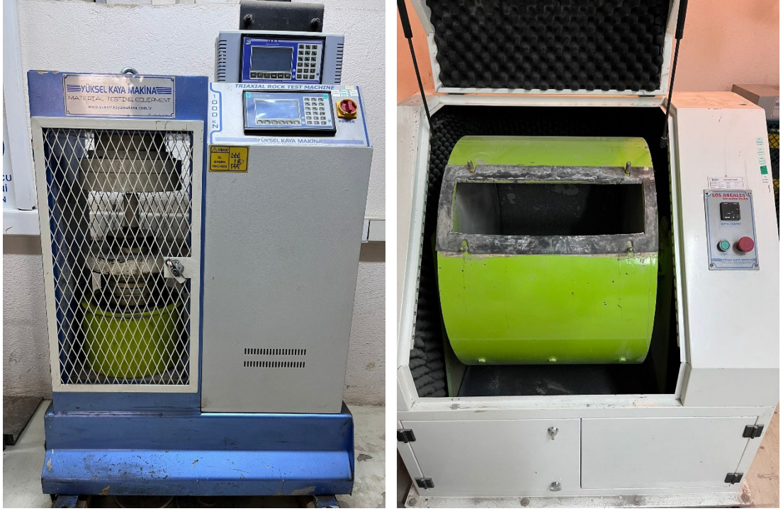
Şekil 4.7. Basınç dayanımı ölçen basınç cihazı ve aşınma dayanımı ölçmeye yarayan Los Angeles cihazı.
