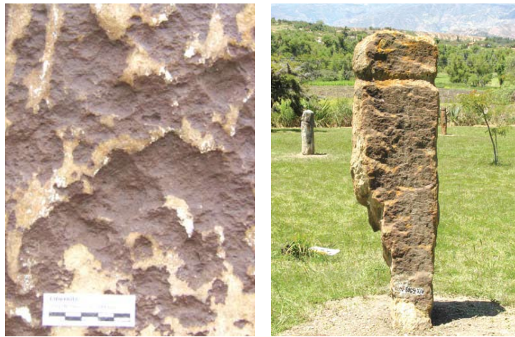
Şekil 5.6. Farklı taş dokular üzerinde erozyon bozulması (Ali & Murat, 2012).
