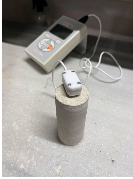
Şekil 4.13. Yazıköy taşı numunesi üzerinde termal iğne probu deneyinin uygulanışı.
