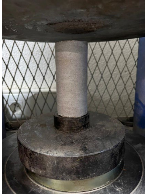
Şekil 4.15. Basınç makinesindeki Yazıköy taşı numunesi.
