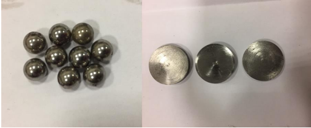
Şekil 5.1. AISI 2205 kalite numuneler ve AISI 52100 kalite aşındırıcı toplara ait görsel.
