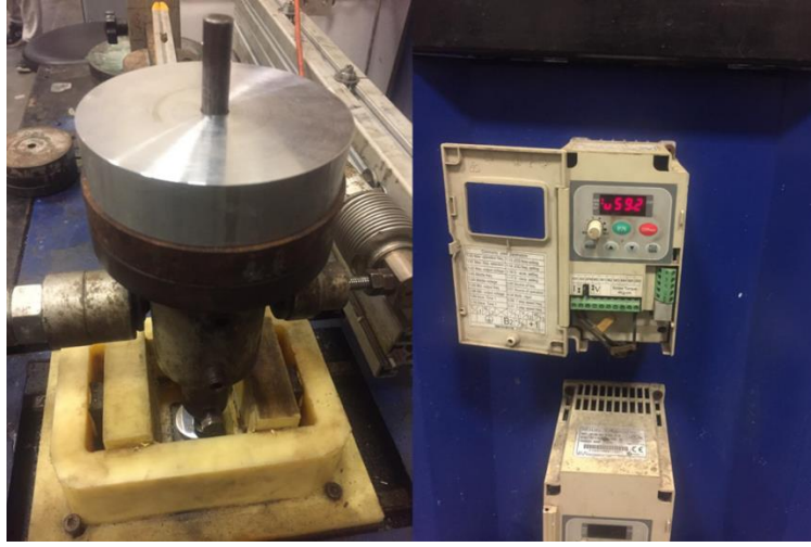
Şekil 5.6. Deneylerde kullanılan yükler ve hız ayar sürücüsü.
