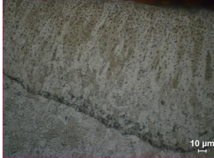
Şekil 8.13 Kaynak sonrası 24 saat kriyojenik işlem uygulanmış numunede ITAB bölgesi
