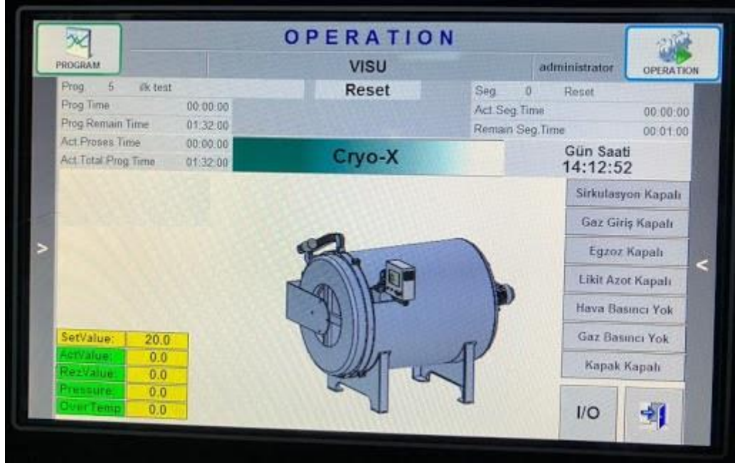
Şekil 7.4 Kademeli soğutma işleminin kontrol edildiği kriyojenik tank operasyon ekranı.
