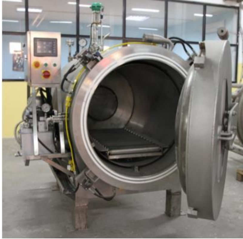
Şekil 5.3 Krijonenik işlemin yapıldığı azot tankı görünümü [41].
