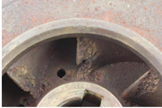
Şekil 3.12. Sulu çamur erozyonuna uğramış aşınma örneği [33].
