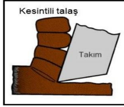
Şekil 3.5. Kesintili talaş türü [17].
