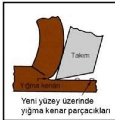
Şekil 3.6. Yığılma talaş türü [17].
