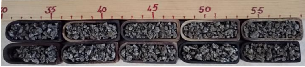
Şekil 5.5. Al_2O_3 kayıkçıklara yerleştirilmiş numuneler (sinterleme sonrası).
