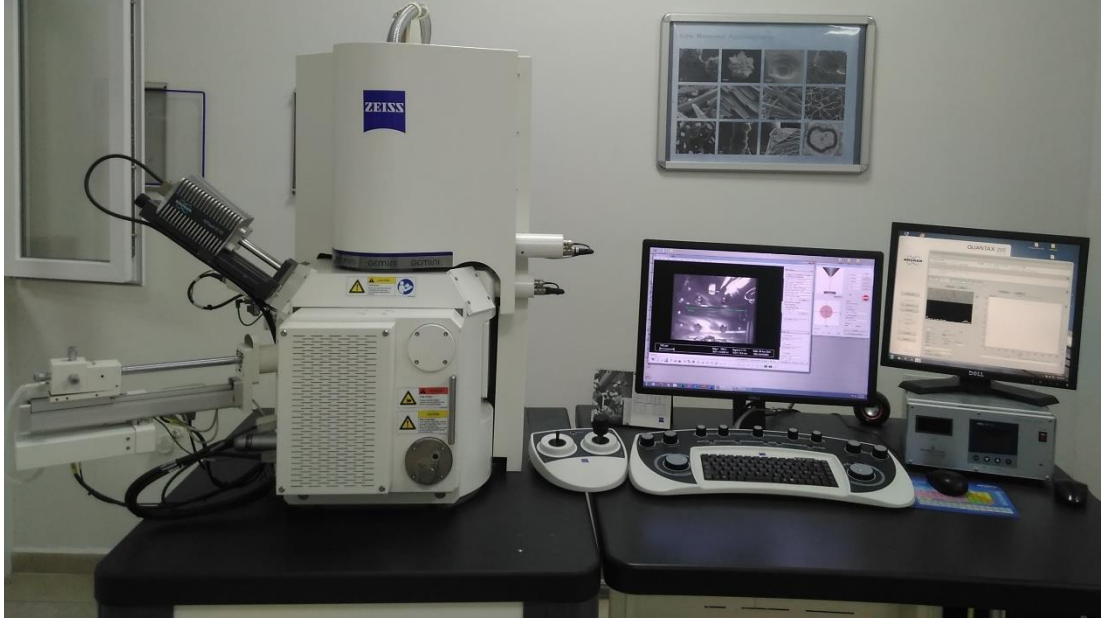
Şekil 5.7. Tarama elektron mikroskobu (SEM).
