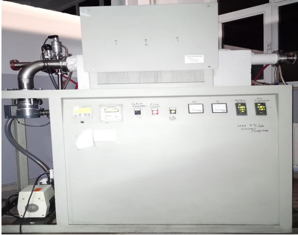
Şekil 5.3. Süperalaşım numunelerin sinterlendiği vakumlu sinter fırını.
