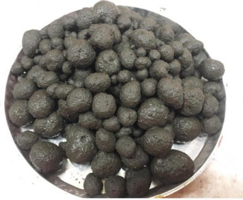
Şekil 6.16. Fayalit yapılı çamurdan elde edilen ham peletler.
