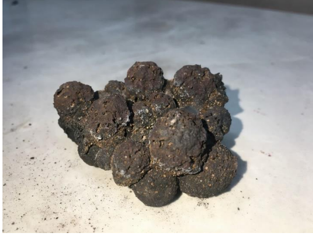
Şekil 6.18. Fayalit karakterli peletlerin gaz fırınında redüklenmesi sonucu görüntüsü.
