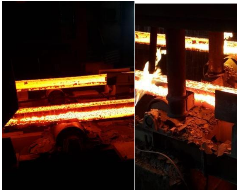
Şekil 3.3. Soğuma boyunca kütük üzerinde oluşan tufal tabakası [9].
