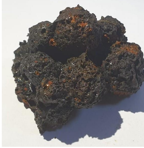
Şekil 7.1. Gaz ocağında redüklenen peletler.
