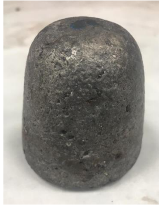
Şekil 6.20. Ark ocağında neticesinde ergitilerek kalıba dökülmüş demir kütlesi.
