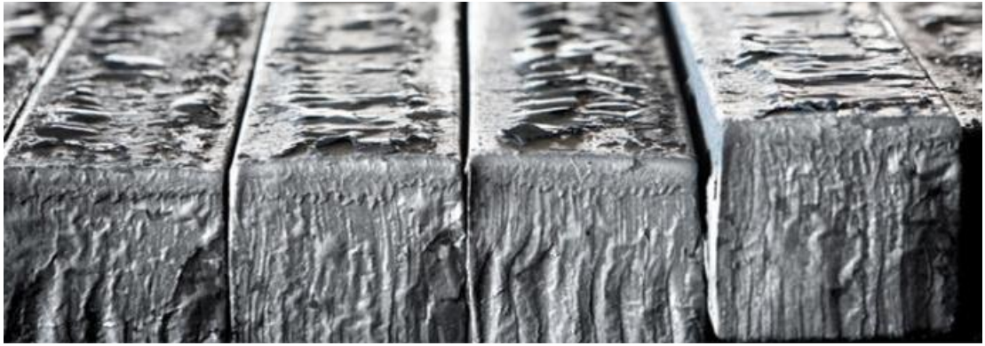
Şekil 3.2. Kütük üzerinde oluşan tufal [9].
