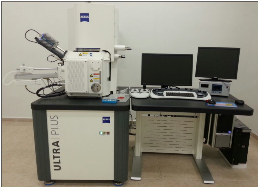
Figure 4.9 Carl Zeiss ultra plus Gemini FESEM.
