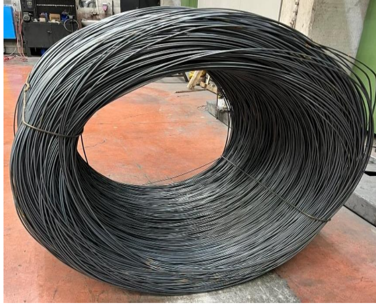
Şekil 4.2. Kullanılan 6 mm filmaşın.
