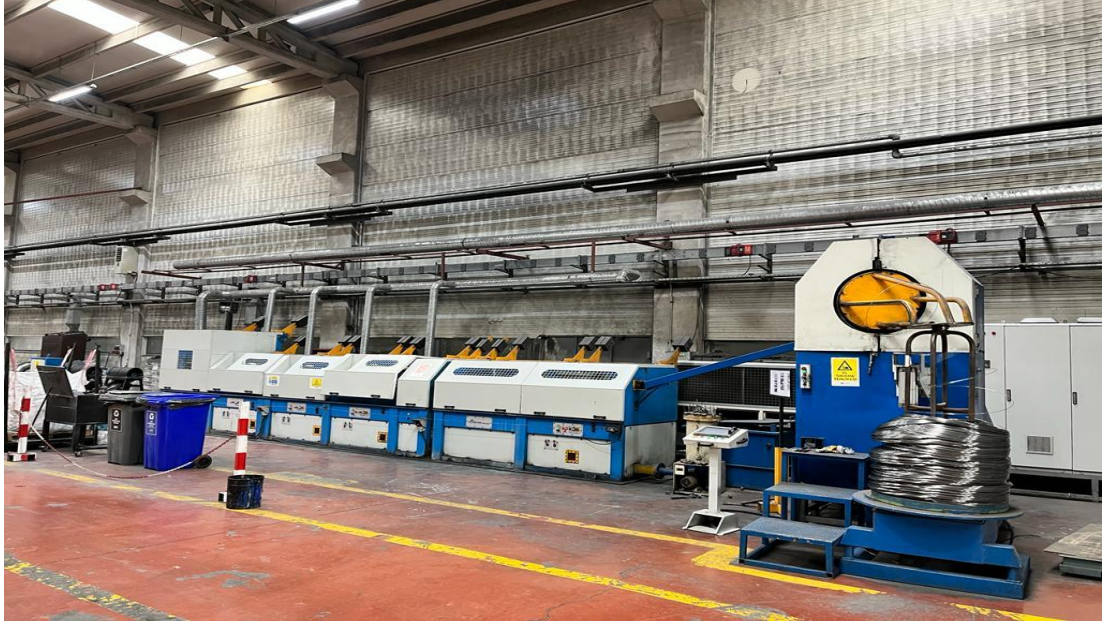
Şekil 8.1. 5 kafa tel çekme makinesi boydan görüntü.
