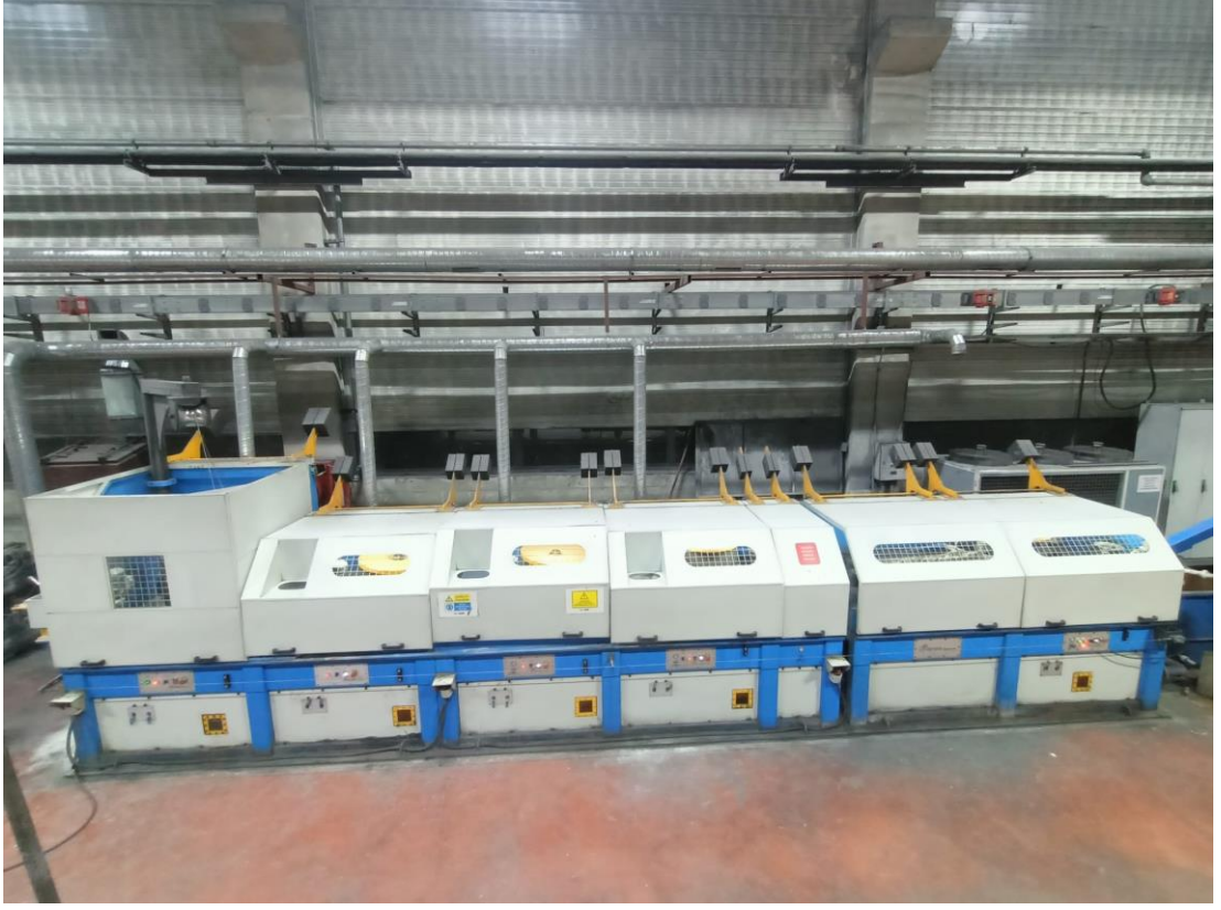
Şekil 4.1. 5 kafalı tel çekme makinesi.
