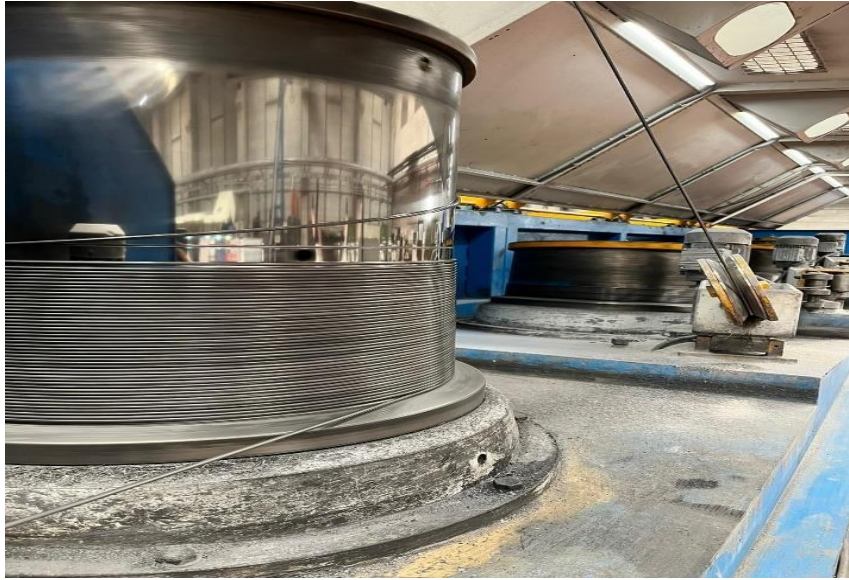
Şekil 4.7. Tel çekme kafası tungsten karbür kaplama görüntüsü
