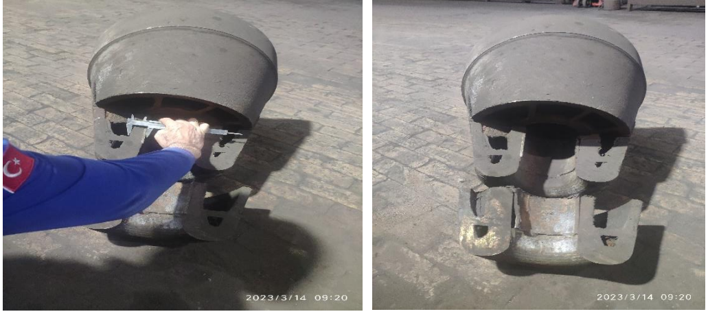
Şekil 5.2. Kontrollü Tüyer Kesimi ve Kesit Görünümü.
