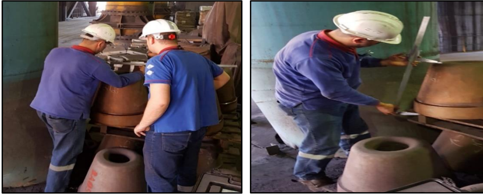
Şekil 4.7. A Firmasına ait tüyerlerine Teknik resime göre ölçü kontrolü.
