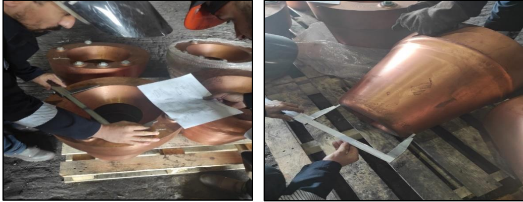
Şekil 4.19. C Firmasına ait tüyerlerine Teknik resime göre ölçü kontrolü
