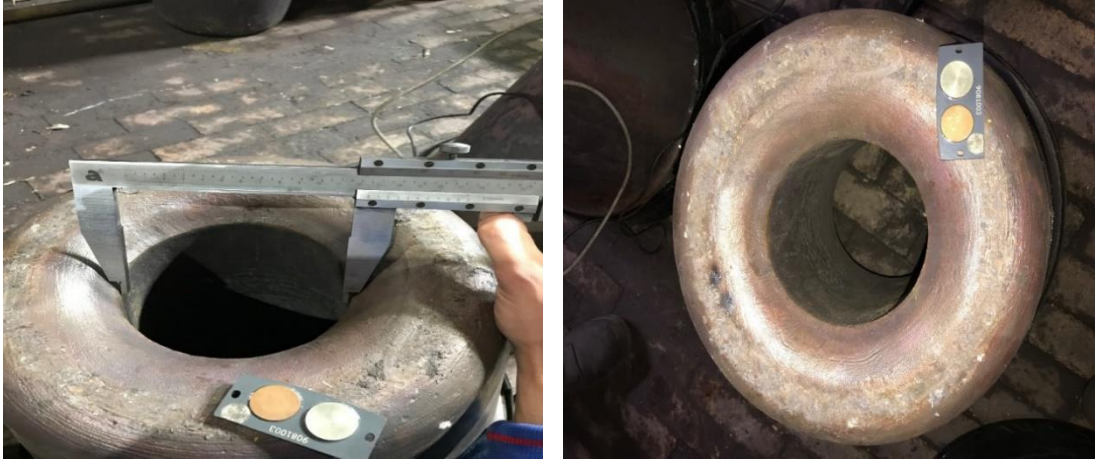
Şekil 4.13. B Firmasına ait tüyerlerine Teknik resime göre ölçü kontrolü.
