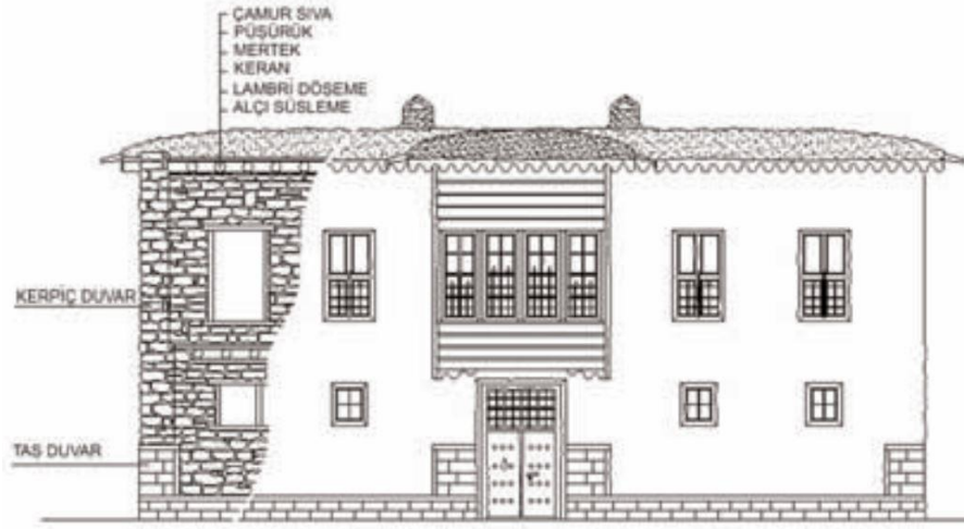
Şekil 2.29. Karma sistem kerpiç uygulama (Tuzaş ve Çobancaoğlu, 2006).
