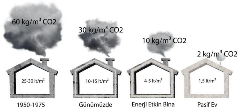
Şekil 2.3. Yapıların enerji tüketimlerine göre CO 2 emisyonlarındaki değişim (İzocam, 2009; Bulut, 2015).
