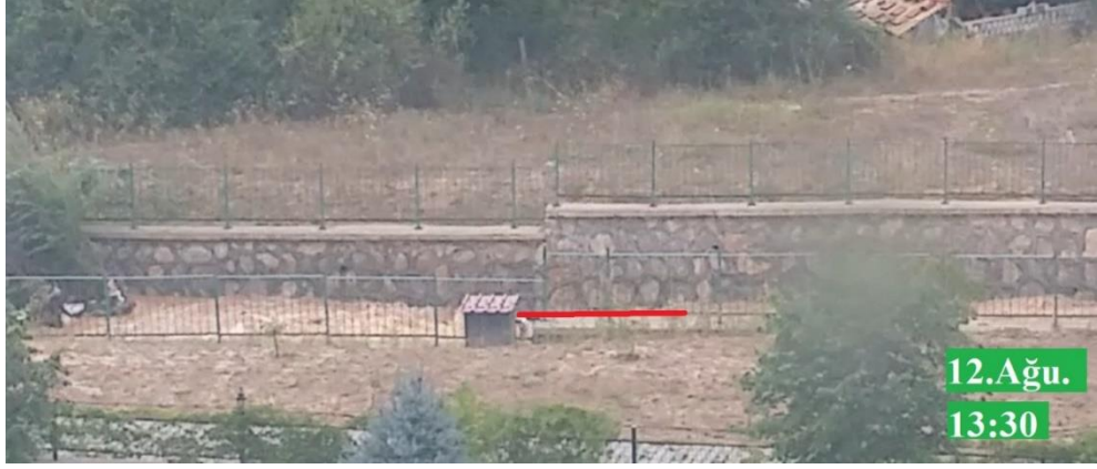
Şekil 4.20. Sađanađın bařlangıcından 41 saat sonra kesitte g zlenmiř su seviyesi
