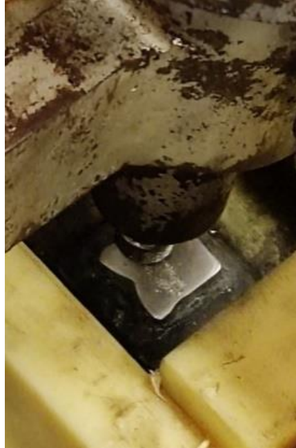
Şekil 4.9. Aşınma cihazına bağlanmış numune görüntüsü.
