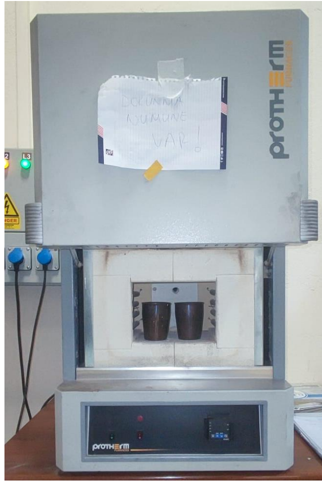
Şekil 3.9. Homojenleştirme işlemi için numunelerin fırına yerleştirilmesi.
