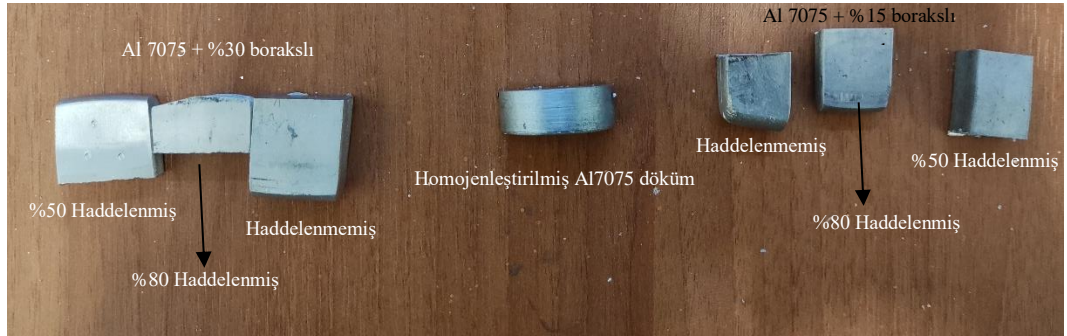
Şekil 3.13. T6 ısıtma işlemi için hazırlanan numuneler.
