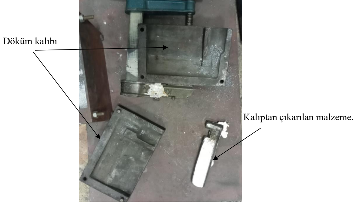
Şekil 3.7. Döküm kalıbı ve dökülen metalden elde edilen parça.
