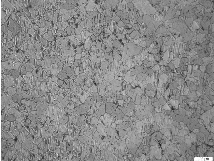
Şekil 5.27. 72 saat T6 ısıt işlem görmüş %80 haddelenmiş %15 borakslı Al7075 10 X büyütmede metalografik görünümü.
