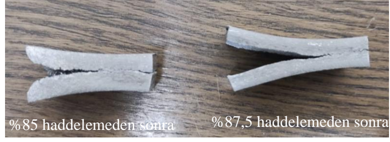
Şekil 3.12. Al7075 + %15 boraks alaşımının %100 haddeleme oranına yaklaştığında numunede yaşanan çatlamlar.
