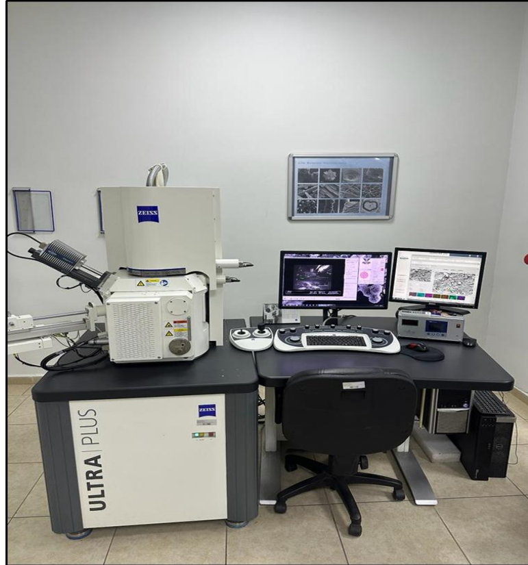
Şekil 4.11. Zeiss markalı taramalı elektron mikroskobunun görüntüsü.
