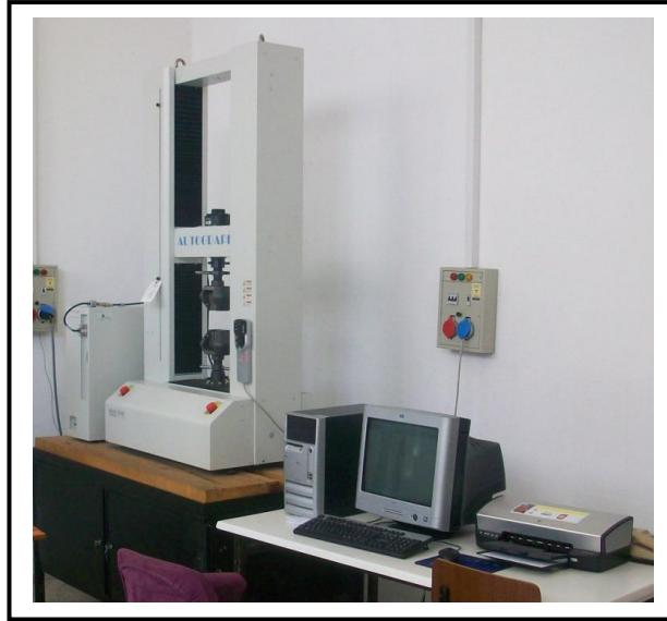
řekil 4.16. SHIMADZU marka çekme test cihazının görüntüsü.
