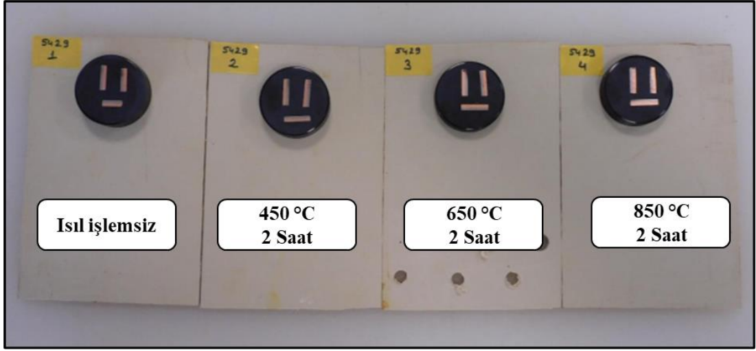
Şekil 4.25. Cu-Ti kompozit malzemelerinden hazırlanan nötr tuz püskürtme test numuneleri.
