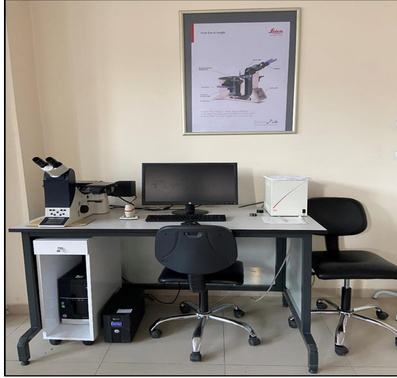
Şekil 4.9. Mikroyapı alma işlemlerinde kullanılan LEICA DMI 5000 M markalı OM görüntüsü.
