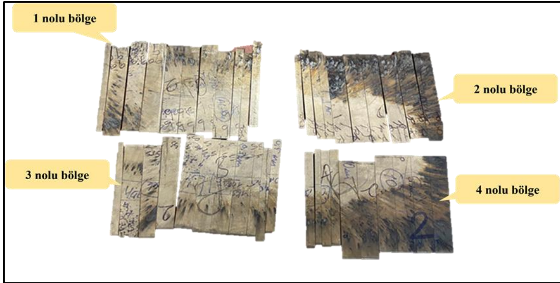
Şekil 4.7. Tel erozyon yöntemi ile hazırlanmış numunelerin görüntüleri.
