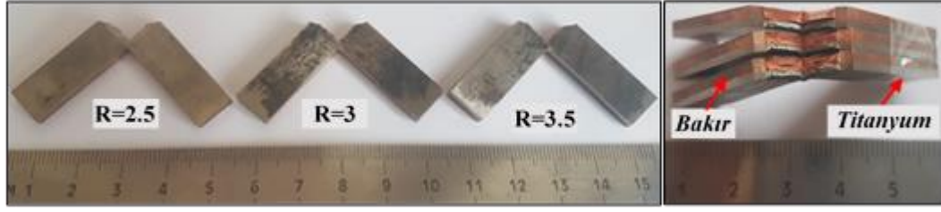
Şekil 5.31. Isıl işlem uygulanmamış Cu-Ti bimetallik kompozit malzemelerinin çentik darbe testleri sonrası makro görüntüleri.
