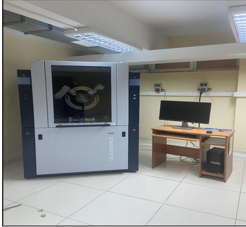
Şekil 4.12. Advance D8 Buruker marka X-ışını cihazının görüntüsü.
