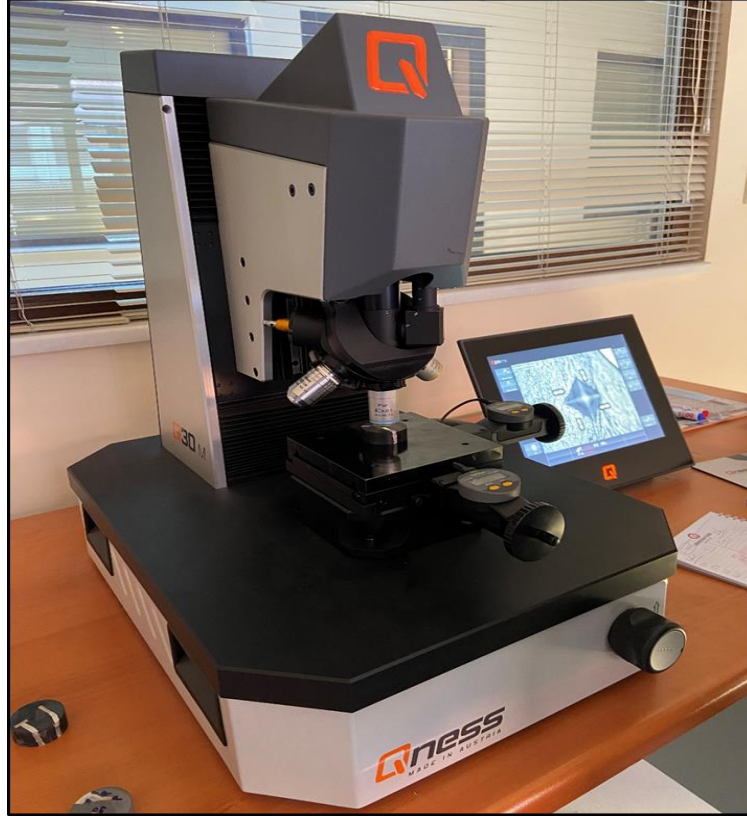
Şekil 4.13. Q30 M Qness marka mikrosertlik ölçüm cihazının görüntüsü.
