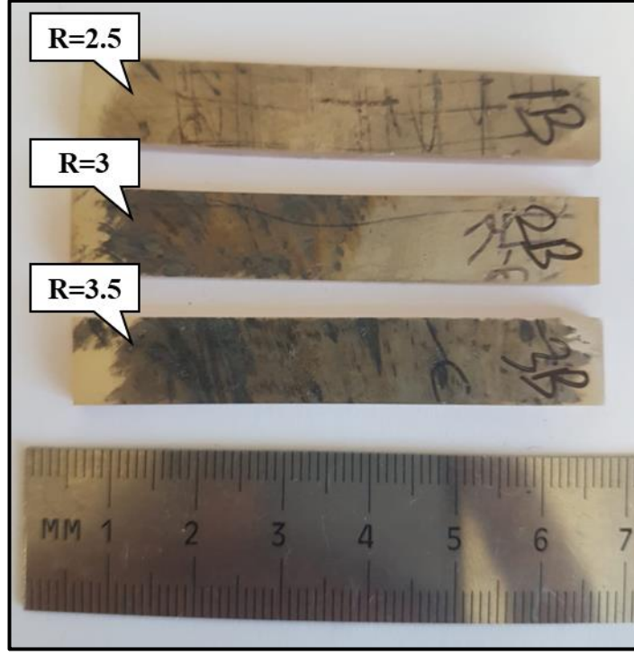
Şekil 4.24. Cu-Ti kompozit malzemelerinden hazırlanan burulma test numuneleri.
