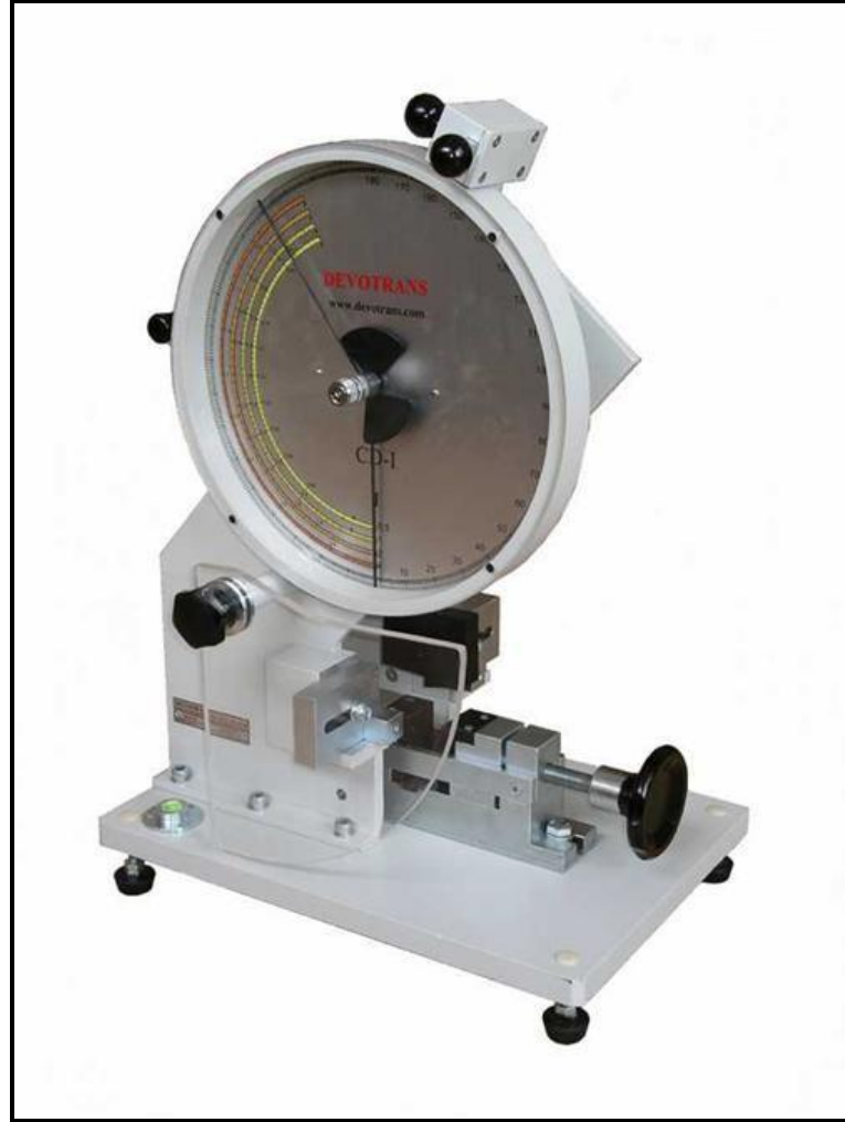
Şekil 4.20. Devotrans markalı çentik darbe test cihazının görüntüsü.
