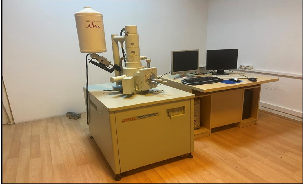
Şekil 4.10. Joel 6060 markalı taramalı elektron mikroskobunun görüntüsü.
