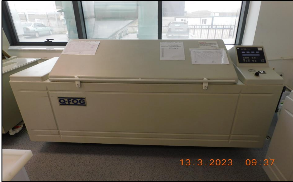
Şekil 4.26. SAL 600 TL tipi tuzlu sis korozyon cihazı görüntüsü.
