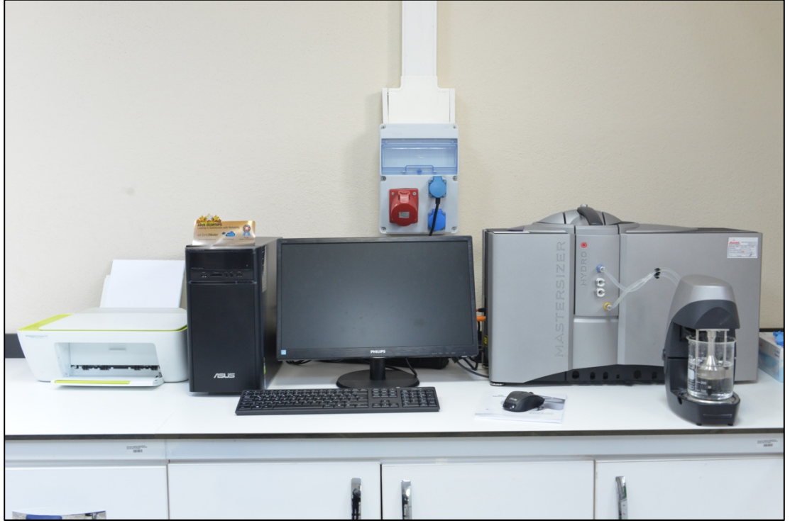
Şekil 3.8. Partikül Boyutu Ölçüm Cihazı, Malvern Mastersizer 3000 (Bartın, Türkiye)
