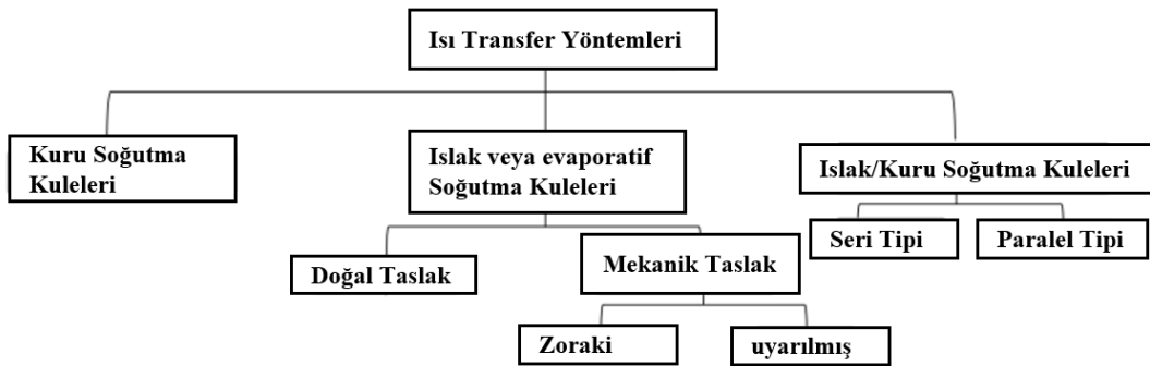
Şekil 3.9. Soğutma kulelerinde kullanılan ana ısı transfer yöntemleri [100].
