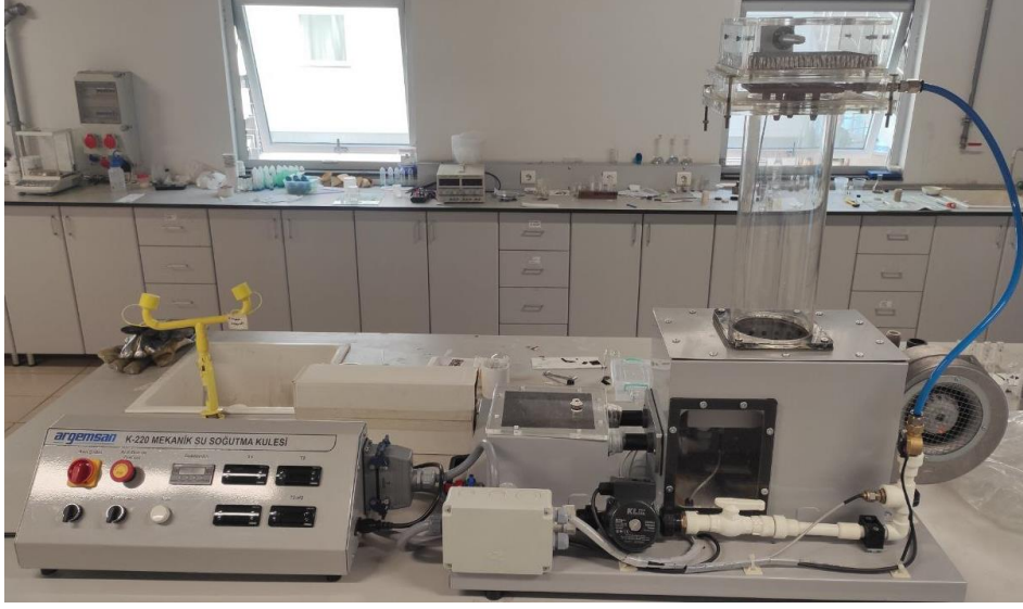
Şekil 5.20. Laboratuvar Ölçekli Mekanik Hava Çekmeli Soğutma Kulesi.
