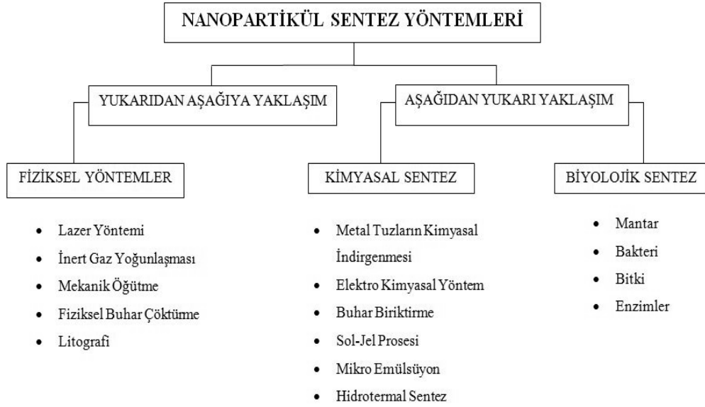
Şekil 2.7. Nanopartikül üretim yöntemlerinin şematik gösterimi [38].
