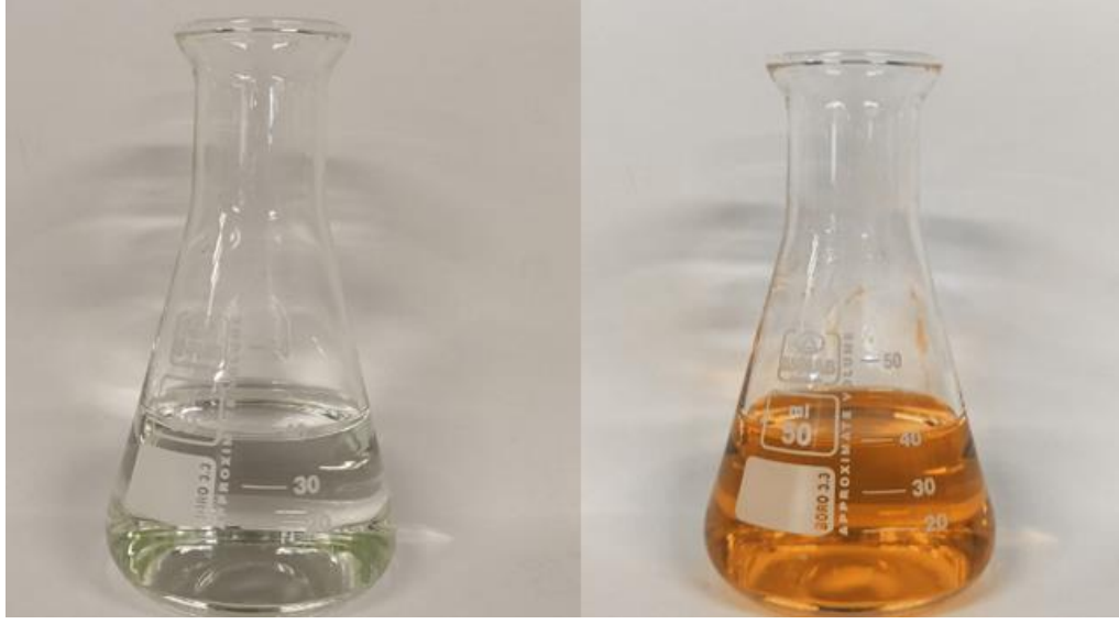
Şekil 5.1. Soldaki resim, herhangi bir eklemeyen önceki DEG'yi, sağdaki ise DEG içinde tamamen çözülmüş FeCl_3 'ü göstermektedir.
