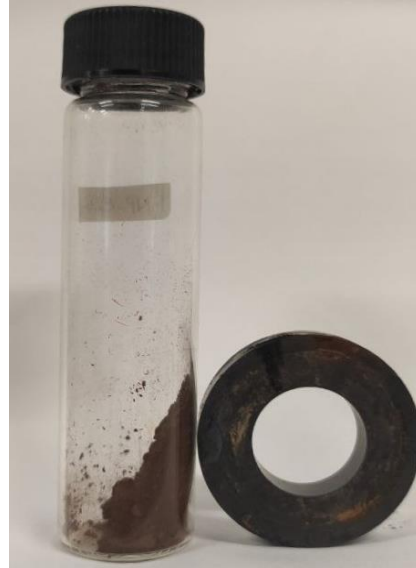
Şekil 5.10. MNP'lerin manyetik özellik gösterdiğini gösteren resim.
