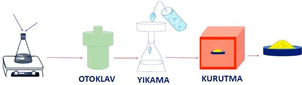
Şekil 2.4. hidrotermal yöntem çalışma prensibi [34].
