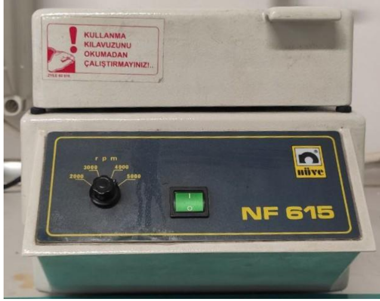
Şekil 5.5. Nanopartikülleri toplamak ve yıkamak için kullanılan santrifüj.
