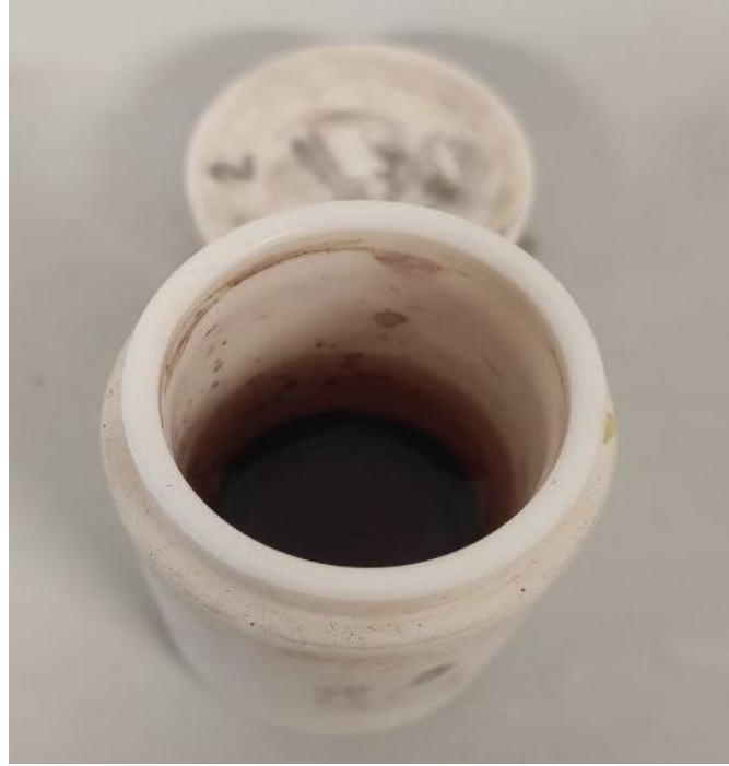
Şekil 5.4. Fırından çıktıktan sonra teflon içindeki karışım.
